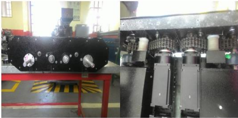
Figura 81 Montaje de placas laterales y sensores
