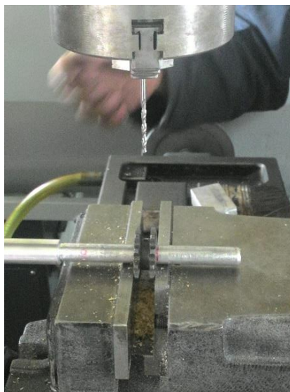
Figura 74 Perforación en ejes para pasadores
