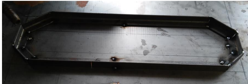
Figura 66 Matriz de hierro para soporte de la estructura
