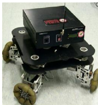
Figura 15 Disposición de ruedas del robot omnidireccional de 4 ruedas orientables.
