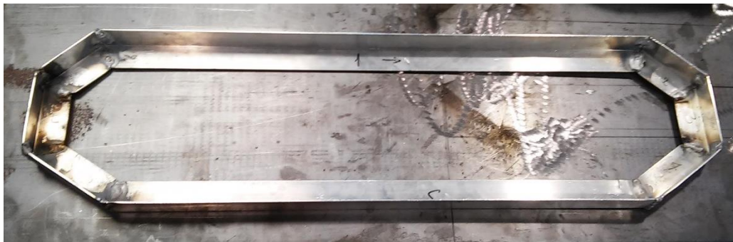
Figura 67 Estructura lateral de soporte
