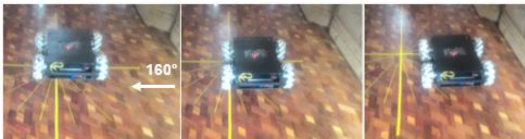
Figura 91 Desplazamiento de la plataforma a 160^\circ
