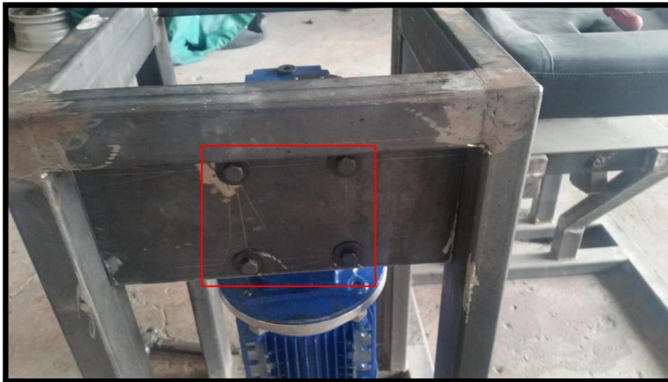
**Figura 31: Montaje Motor**
