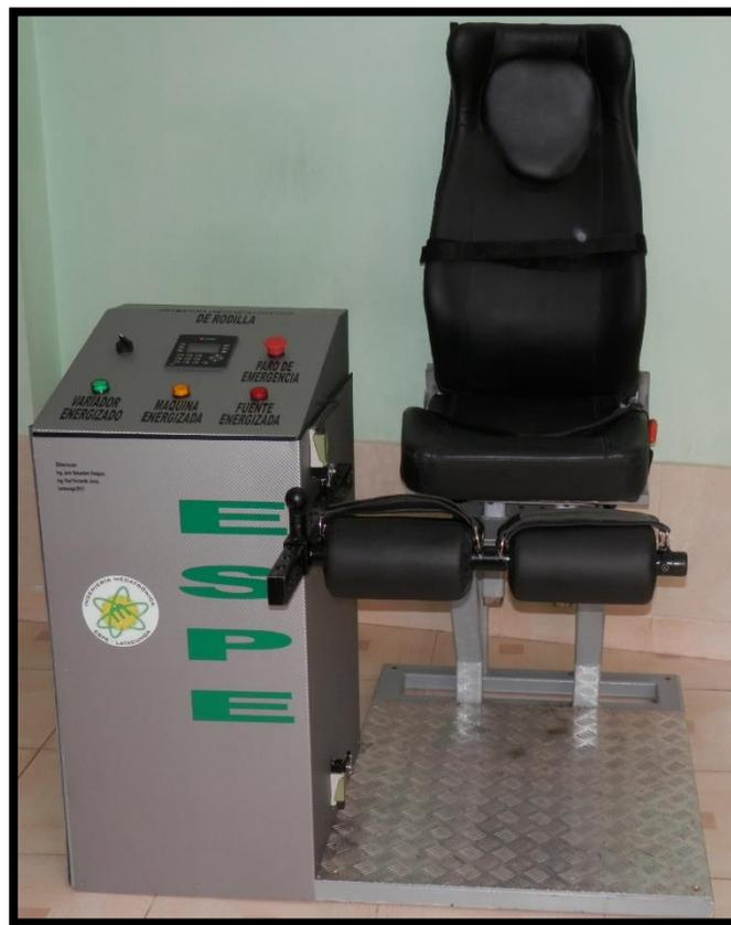
Figura 33: Ensamblaje Órtesis Automatizada de Rodilla
