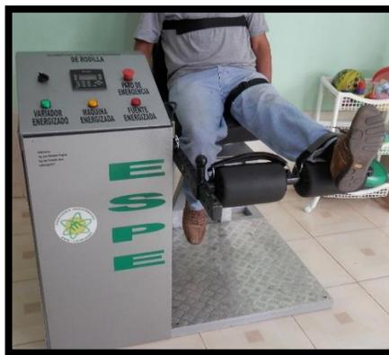
**Figura 47: Prueba Modo Manual Movimiento Ascendente 90°**
