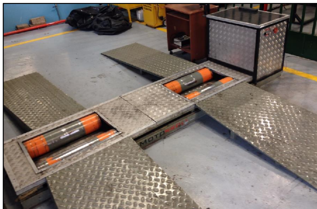
Figura 63 Dinamómetro de rodillos Motorroll
