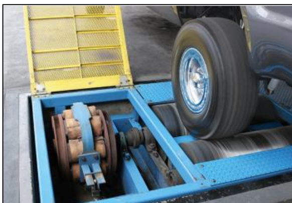
Figura 28 Dinamómetro de chasis con sistema de frenado. Fuente: (Hernández V, 2007)
