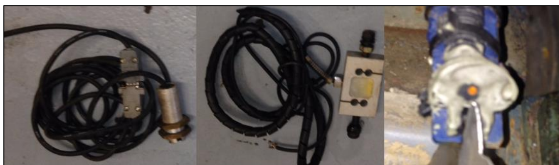
Figura 38 Sensor de revoluciones y celda de carga
