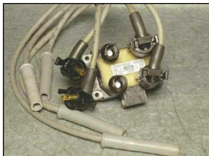
Figura 19 Bobina DIS Fuente: (Denton T, 2012)
