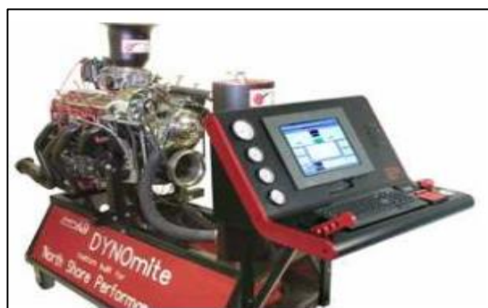
Figura 27 Dinamómetro de motor. Fuente: (Hernández V, 2007)
