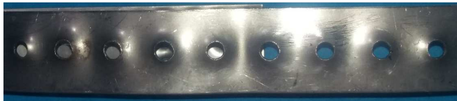
Figura 17 Matriz 9mm espesor 1,5mm
