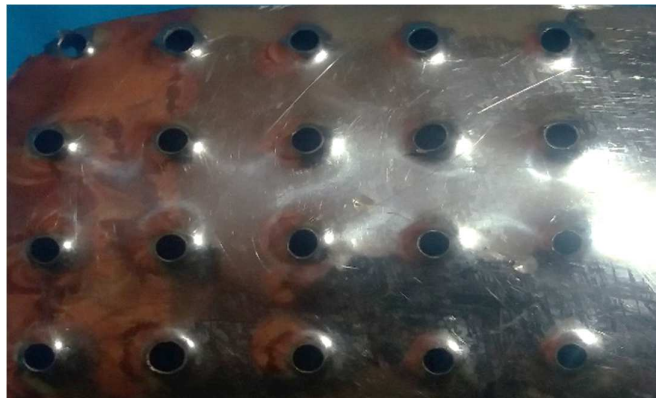
Figura 19 Matriz punzón de 6mm espesor 1mm
