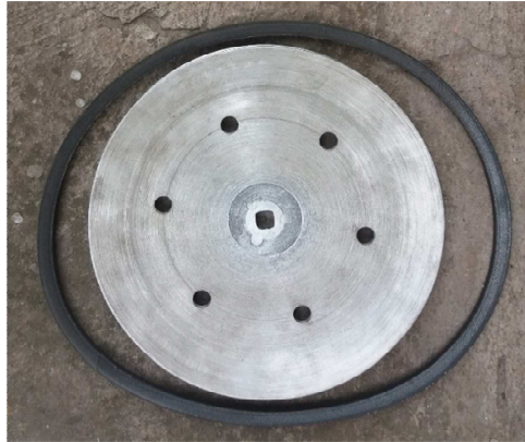
Figura 37 Polea de diámetro interno 160mm y banda de 28 pulg.
