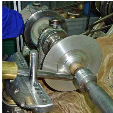
Figura 54 Repujado de una lámina circular
