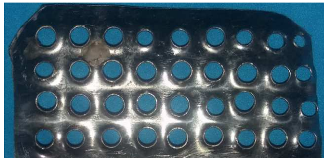
Figura 16 Matriz punzón 9mm espesor 1mm
