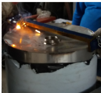
Figura 59 Soldadura alrededor de la estructura externa
