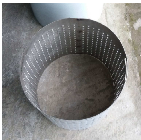
Figura 49 Barolado estructura cilíndrica rugosa
