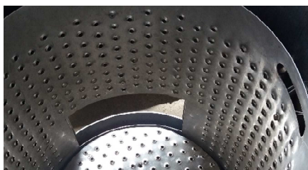
Figura 50 Cortes para las compuertas
