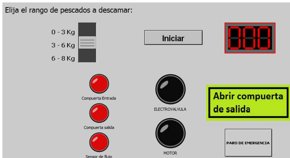
Figura 75 Indicador para abrir compuerta de salida
