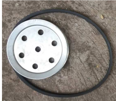
Figura 35 Polea de diámetro interno 100mm y banda de 24 pulgadas
