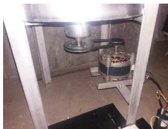
Figura 60 Fijación del motor y transmisión
