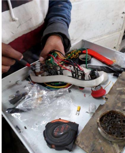
**Figura 89 Conexiones de la botonera al control remoto.**
