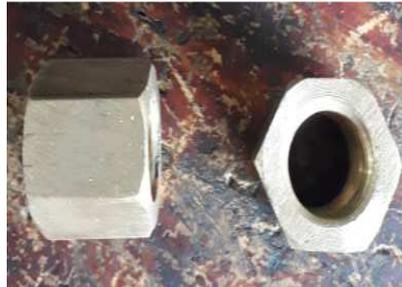
**Figura 66 Tuercas hexagonales de bronce maquinadas en torno.**
