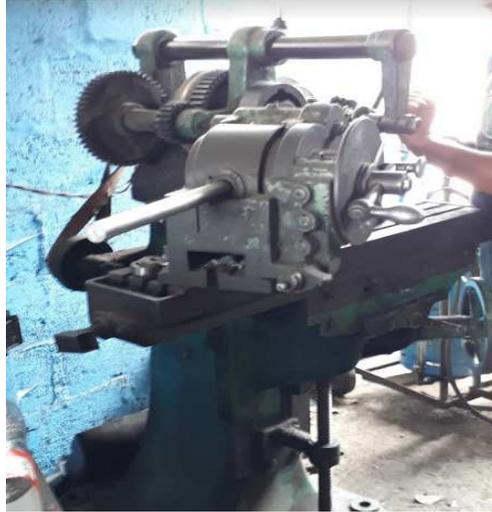
**Figura 70 Torneado de tornillos sin fin .**
