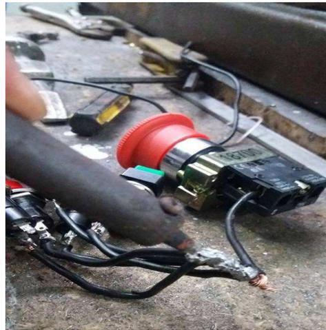
**Figura 86 Elaboración de conexiones para botonera.**
