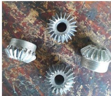
**Figura 67 Piñones cónicos maquinados en fresadora.**
