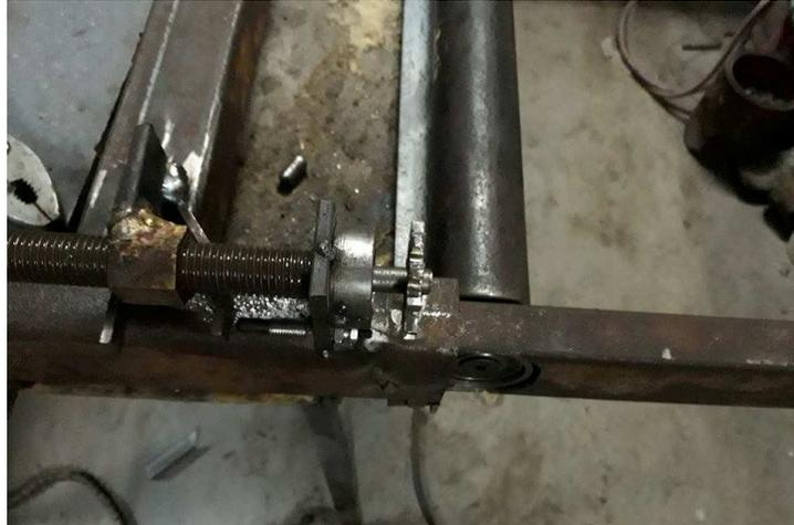
**Figura 74 Acople de catalina a tornillo sin fin.**
