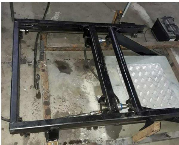
**Figura 84 Secado de pintado de la plataforma a temperatura ambiente.**
