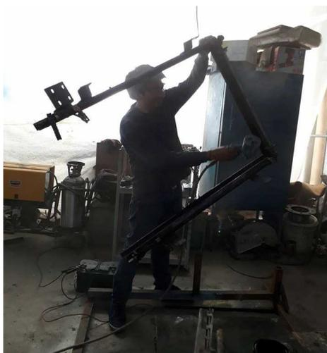
**Figura 83 Proceso de pintura a la estructura del elevador.**
