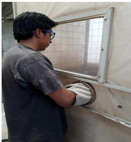
**Figura 82 Proceso de arenado de las partes metálicas.**
