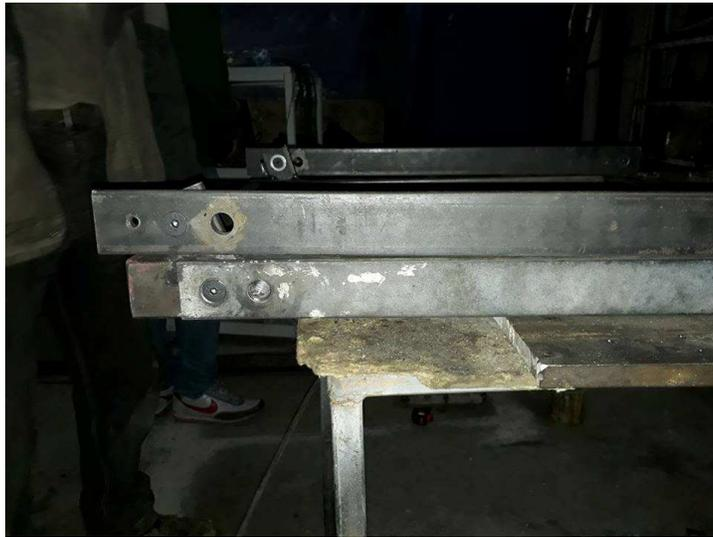
**Figura 76** Ensamble de brazos hidráulicos y de soporte.
