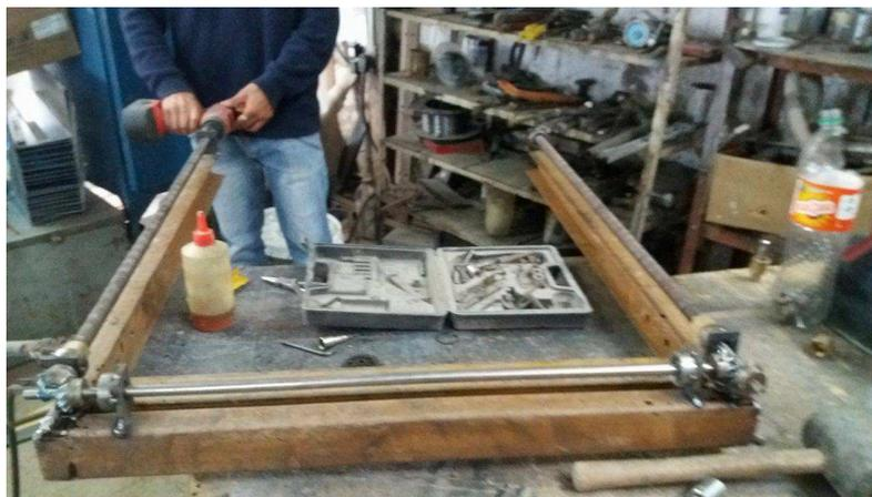
**Figura 72 Prueba sistema de desplazamiento con un taladro.**
