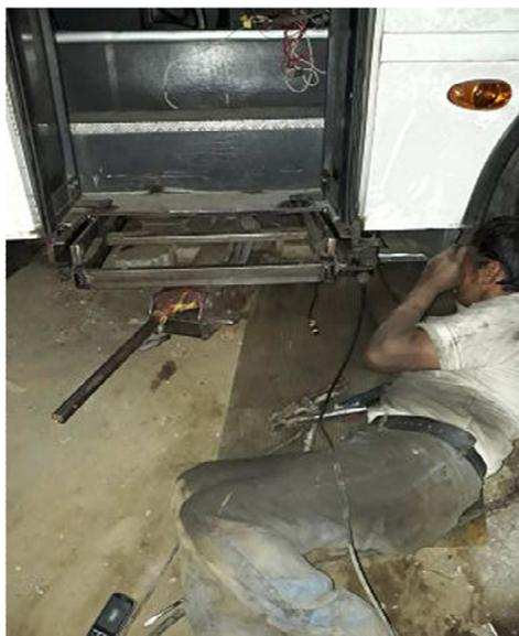
**Figura 95. Sujeción de sistema de elevación a estructura del bus.**
