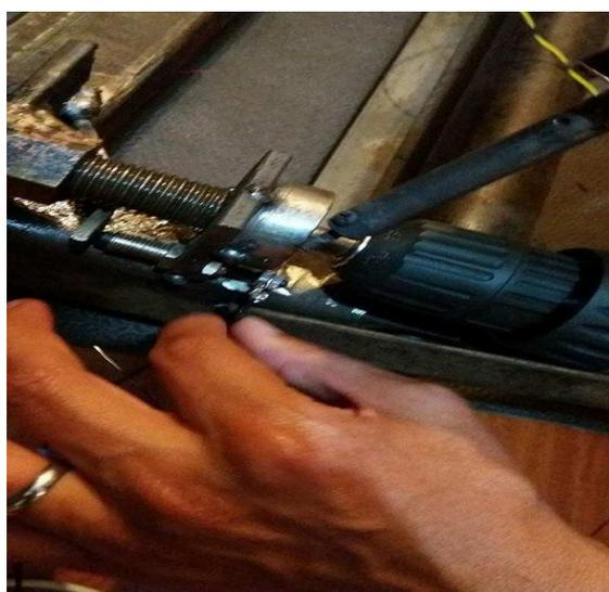
**Figura 85 Instalación de sensor fin de carrera.**
