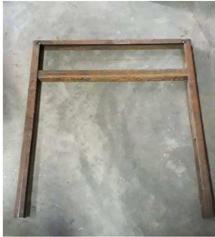
**Figura 64 Base soldada para elevador con soldadura MIG.**
