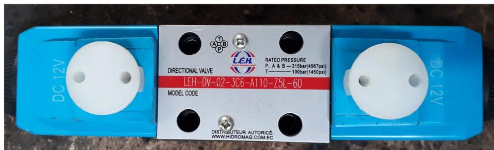
**Figura 37 Electroválvula para el circuito hidráulico.**
