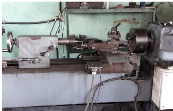
**Figura 65. Maquinado de elementos para el ascensor en torno.**
