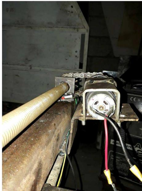
**Figura 75 Sujeción de motor eléctrico a plataforma.**
