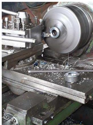
**Figura 68 Maquinado de cajelas metálicas para protección de rodamientos.**
