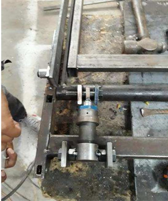
**Figura 77 Acople de cilindros doble.**
