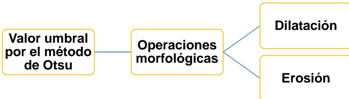
**Figura 26 Diagrama de bloques de la segmentación**
