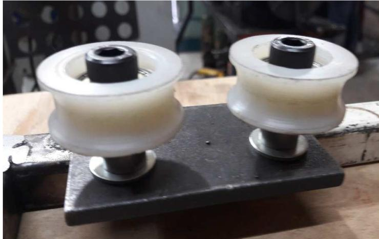
**Figura 95** Sistema para el deslizamiento de la corredera
