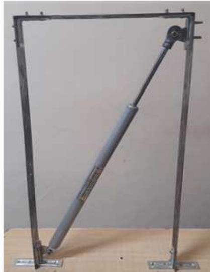
**Figura 122** Montaje del amortiguador en el pórtico
