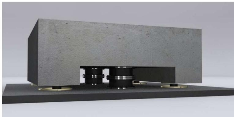
**Figura 9** Amortiguador de masa sintonizada
