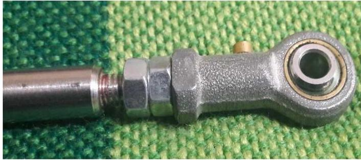
**Figura 101** Elementos de acople ubicados en los extremos de la barra Finalmente se ensamblan todos los elementos y se obtiene el mecanismo para la generación de movimiento.
