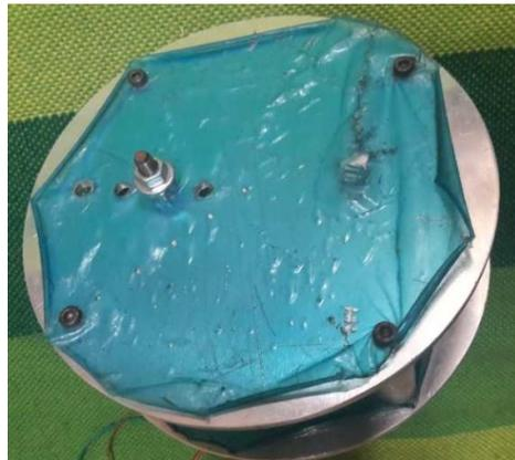
**Figura 99** Disco con la excéntrica que cumple la función de manivela
