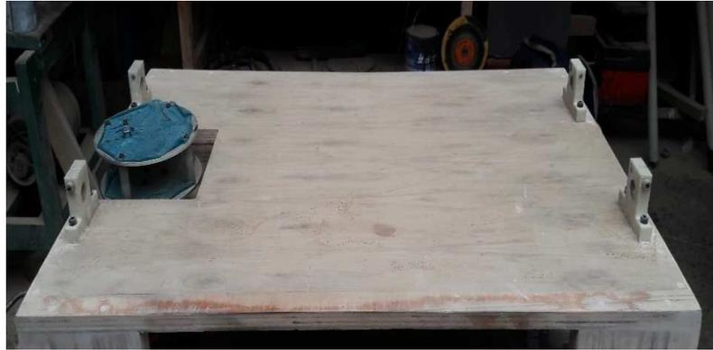
**Figura 110** Montaje de los elementos de sujeción
