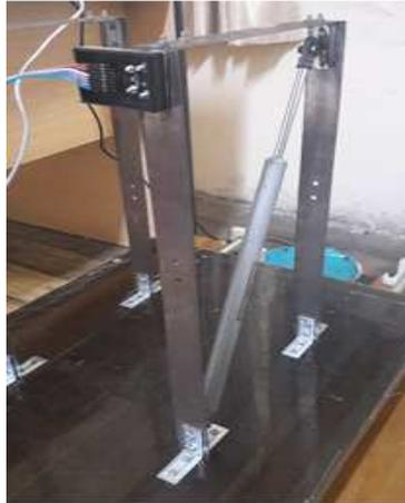
**Figura 135** Ubicación del módulo en el nodo 2 - Pórtico con amortiguamiento
