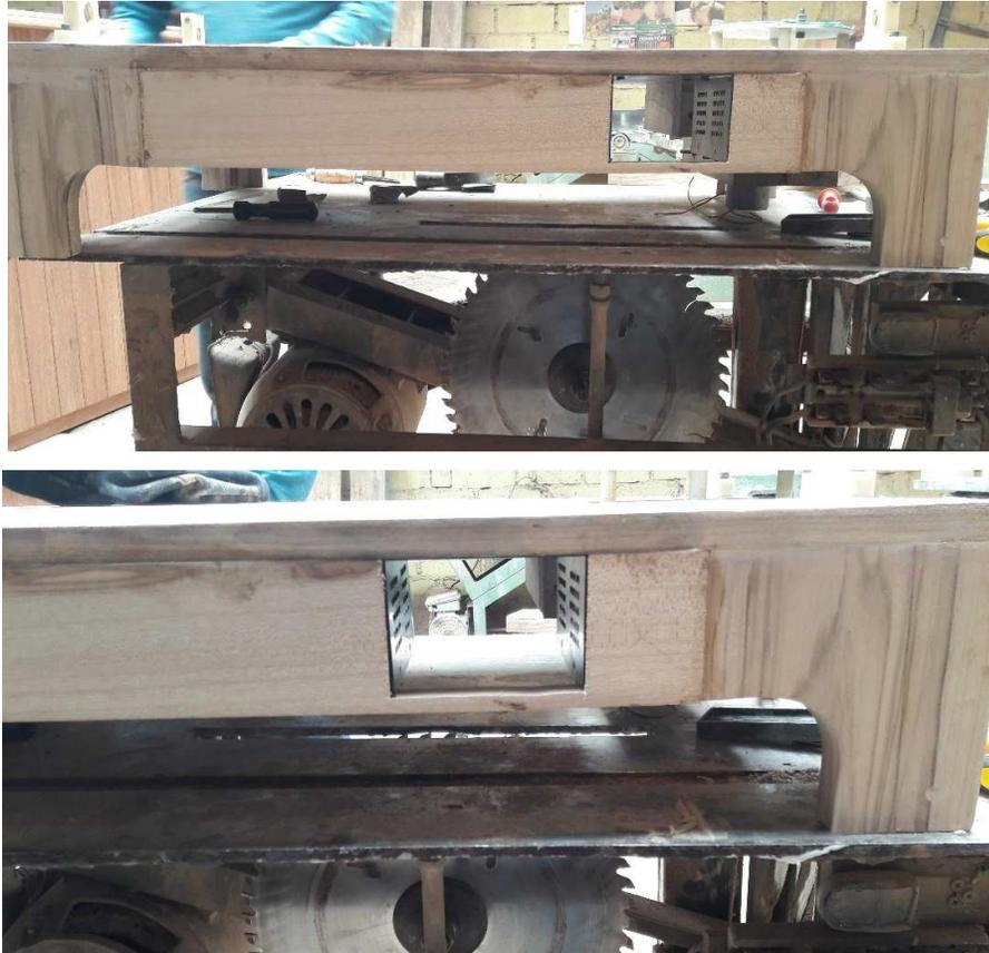
**Figura 108** Elaboración de compartimentos en el bastidor
