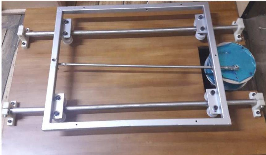
**Figura 102** Mecanismo para la generación del movimiento en la mesa de vibración
