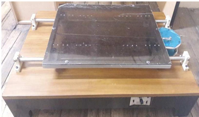
**Figura 116** Mesa de vibración ensamblada
