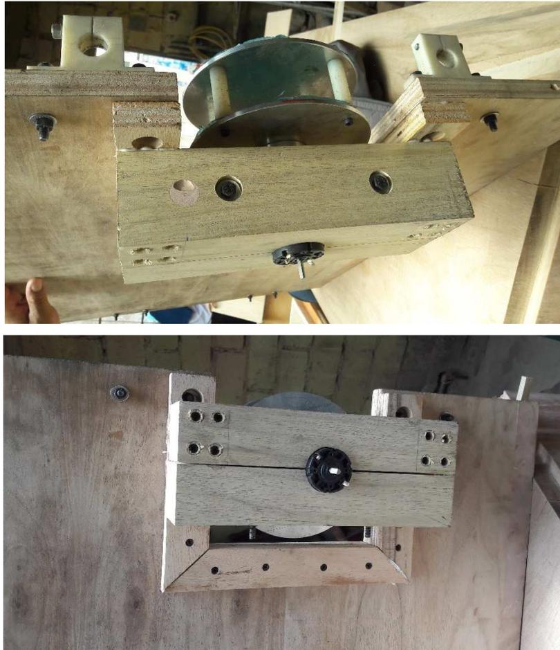
**Figura 106** Sistema para acoplamiento del motor al bastidor
