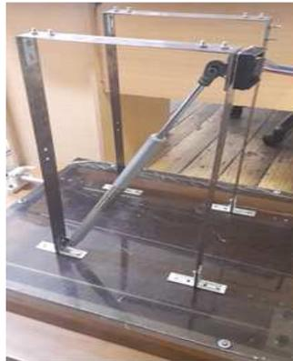
**Figura 139** Ubicación del módulo en el nodo 3 - Pórtico con amortiguamiento
