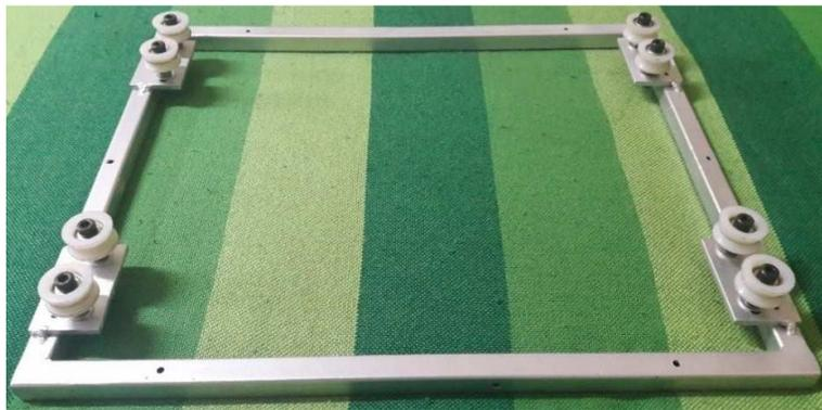
**Figura 96** Montaje del sistema de deslizamiento
