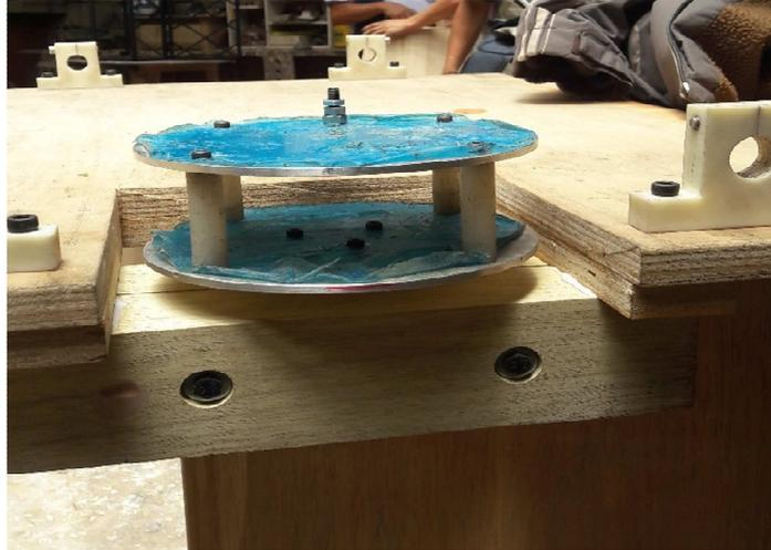
**Figura 105** Madera utilizada como bastidor
