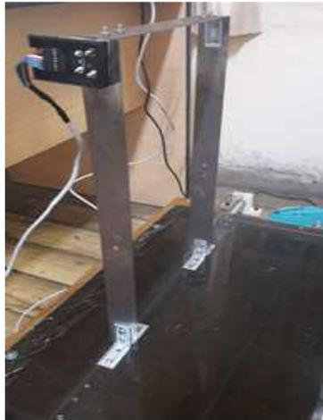
**Figura 133** Ubicación del módulo en el nodo 2 - Pórtico sin amortiguamiento
