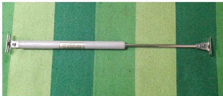
**Figura 30** Elemento de amortiguación
