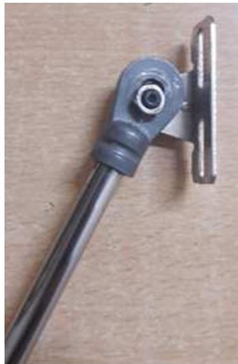
**Figura 121** Elementos de acople en los extremos del amortiguador
