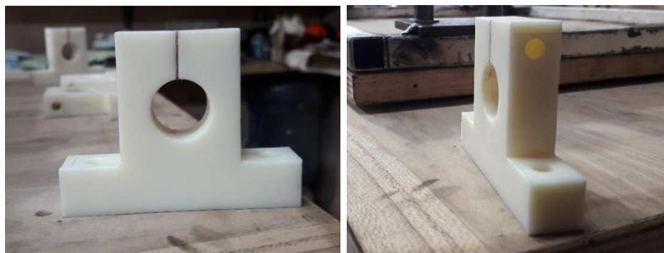
**Figura 109** Elementos para sujeción de guías
