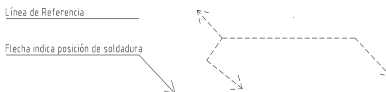
Figura 163: Líneas de referencia de soldadura
