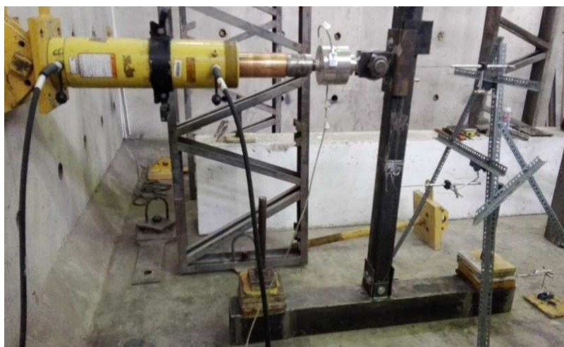
Figura 173: Instalación de LVDT para medición de deformaciones
