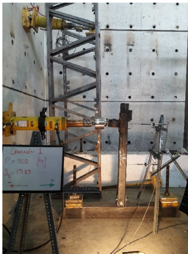
Figura 175: Aplicación de carga 300 kg
