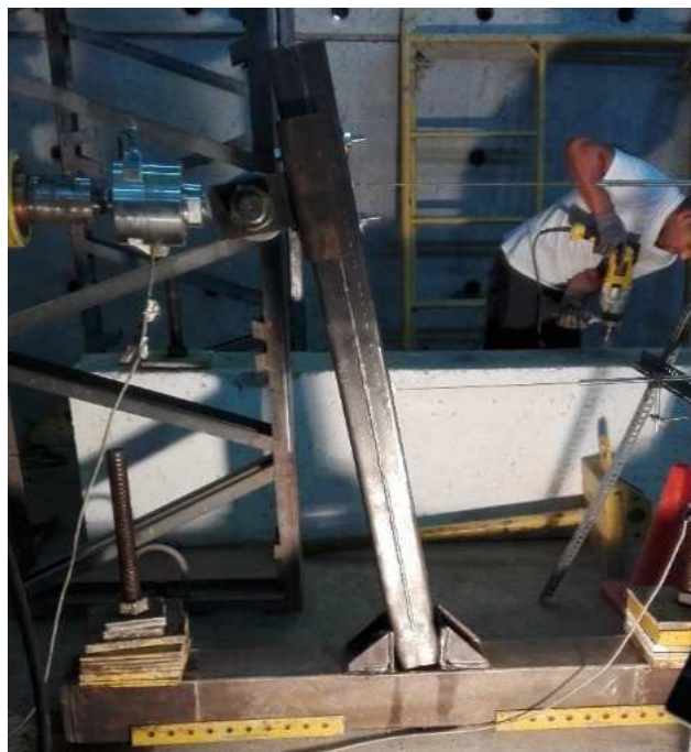
Figura 180: Ensayo de conexión F = -1500 kg
