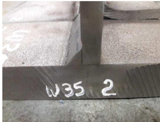
Figura 157: Soldadura a Filete práctica de soldadura ESPE
