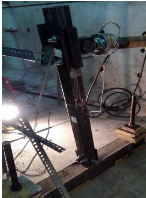
Figura 174: Instalación de probeta para ensayo de conexión
