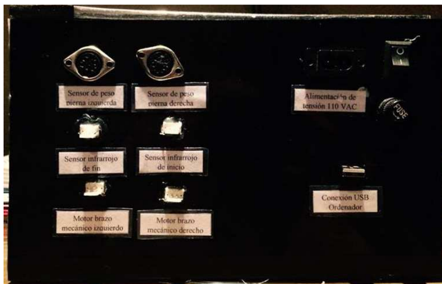
Figura 42. Vista frontal y detalle de distribución de conectores del prototipo.
