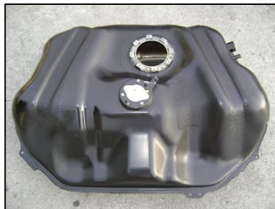
Figura 18 Depósito de combustible
