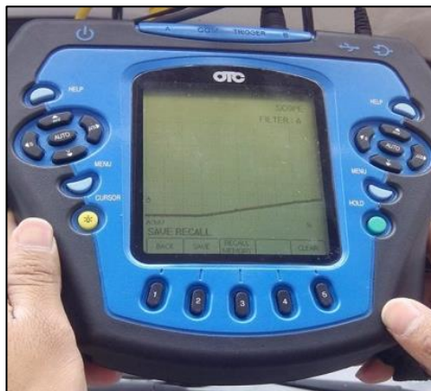
Figura 72 Onda sensor MAF e IAT, Esc. 10V/Div, 1s/Div
