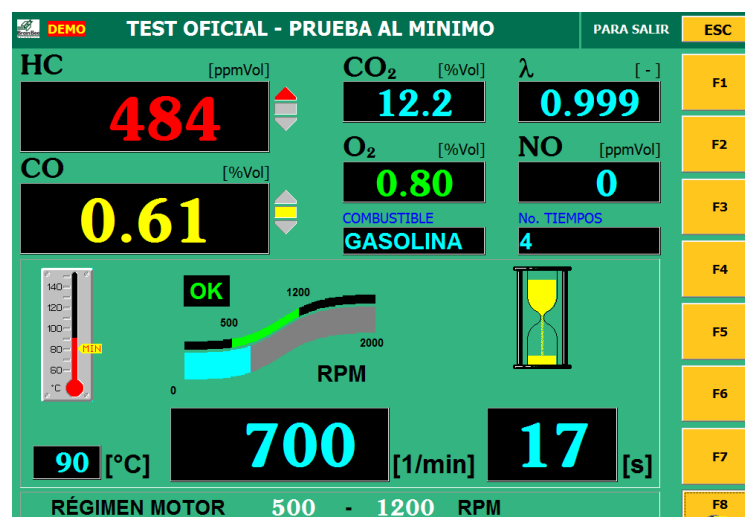
Figura 12 Software del AGS-688 opción prueba al mínimo en test oficial
