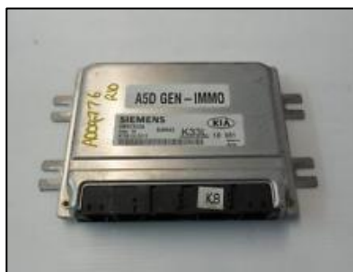
Figura 33 Modulo de control electrónica ECM
