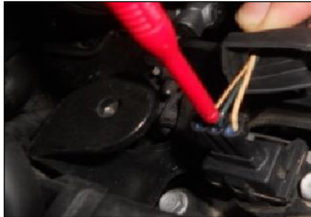
Figura 44 Conexión osciloscopio para sensor CMP
