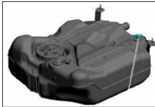
Figura 50 Depósito de combustible.
