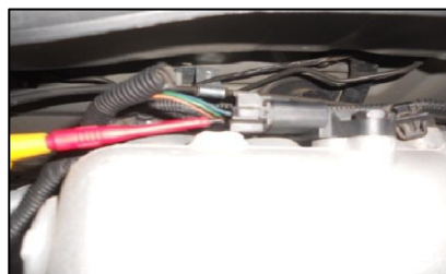
Figura 40 Conexión osciloscopio para sensor T-MAP
