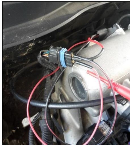
Figura 100 Conexión para simulación en sensor MAP
