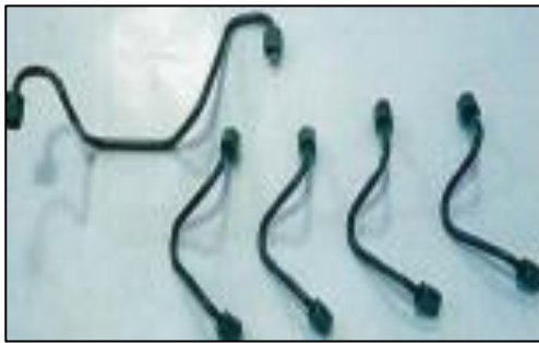
Figura 55 Cañerías de combustible
