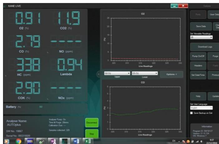
**Figura 66 Medición de gases de escape**
