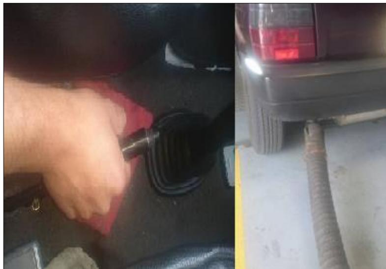
**Figura 30 Extractor de gases de escape**
