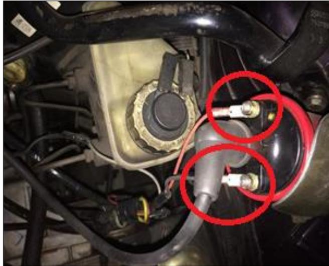
**Figura 28 Cable anaranjado y negro, terminal positivo y negativo de la bobina**
