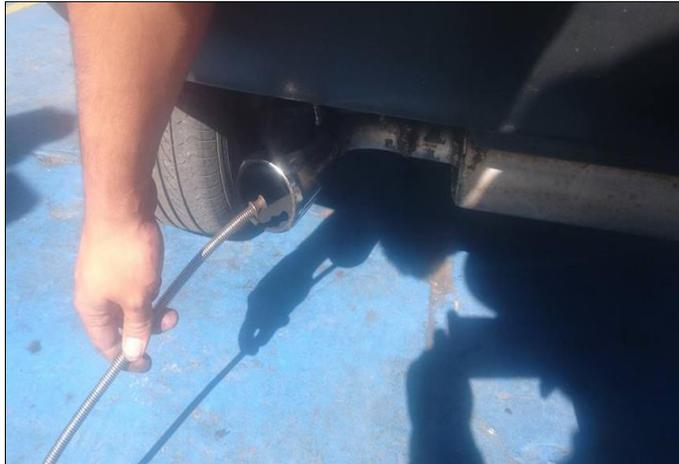
**Figura 63 Conexión sonda de muestro del analizador de gases**
