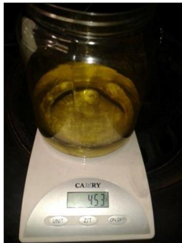
**Figura 59 Peso del combustible antes de la prueba**
