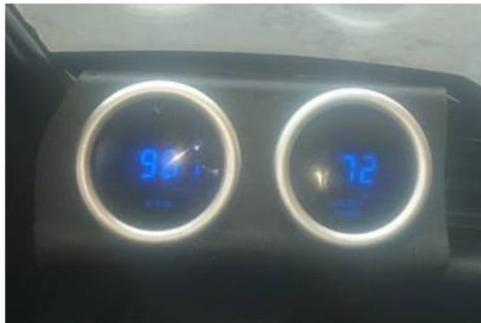
**Figura 64 Temperatura normal de operación del motor**
