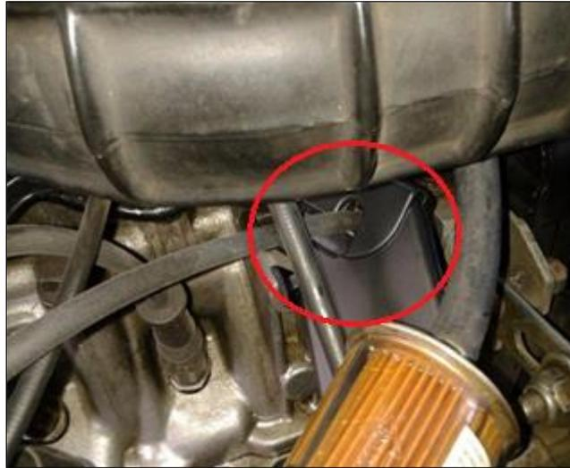
**Figura 54 Conexión de pinza capacitiva**
