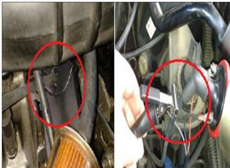
**Figura 53 Conexión para prueba de oscilograma secundario**
