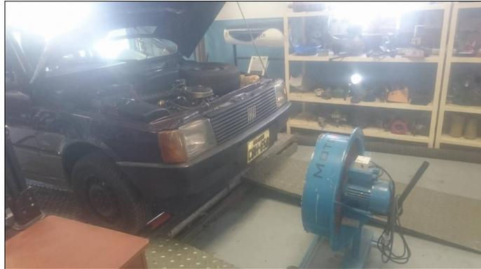
**Figura 33 Ventilador dinamómetro**
