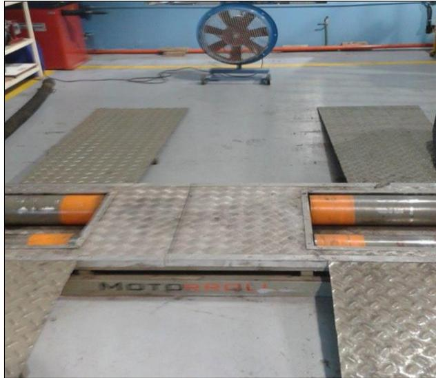
**Figura 17 Dinamómetro de rodillos**
