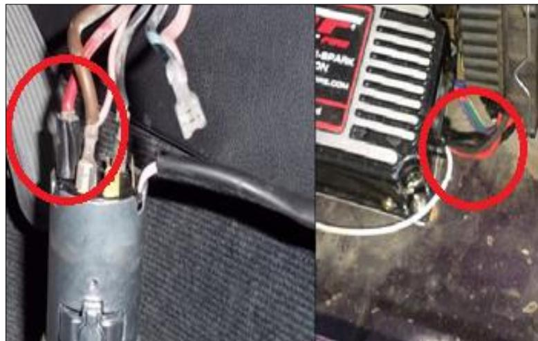
**Figura 27 Cable rojo delgado conexión a llave de ignición**
