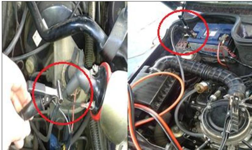
**Figura 55 Conexión de la punta negativa del osciloscopio**
