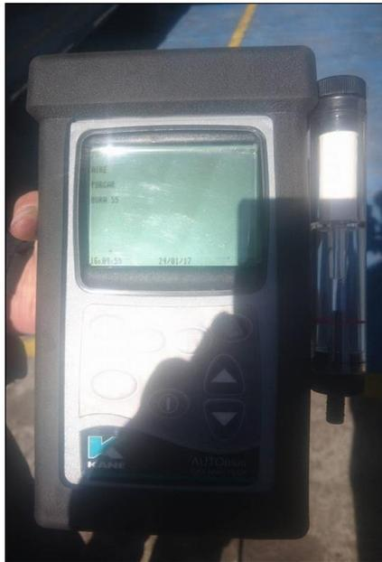
**Figura 61 Analizador de gases AUTOplus Kane**
