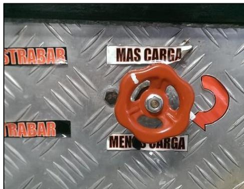
**Figura 34 Aplicación de carga al dinamómetro**
