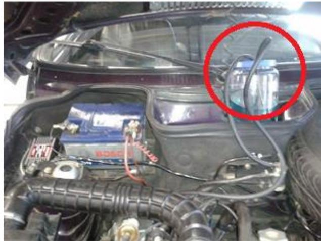
**Figura 58 Conexión de mangueras al depósito de combustible**
