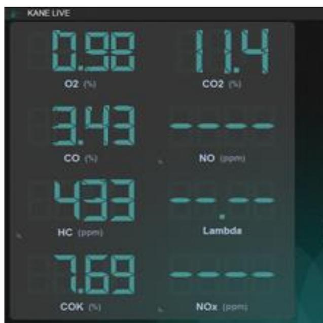
Figura 79 Valores de análisis de gases
