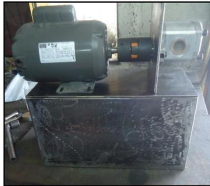
**Figura 135. Implemento de motor eléctrico y bomba**
