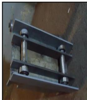
**Figura 128. Ensamble del carro móvil**
