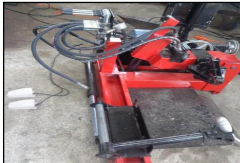
**Figura 138. Conexión de mangueras**
