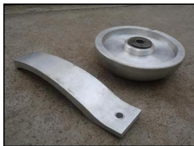
**Figura 131. Maquinado de piezas del carro porta herramientas**
