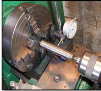
**Figura 125. Ejes para los rodamientos del carro móvil**
