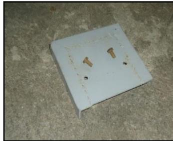
**Figura 130. Tapa de las guías del carro**
