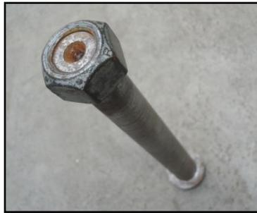
**Figura 123. Perno para unir brazo a estructura**
