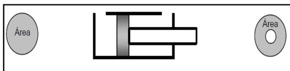
**Figura 23. Cilindro hidráulico de doble efecto**
