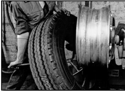
**Figura 3. Desmontaje del neumático**
