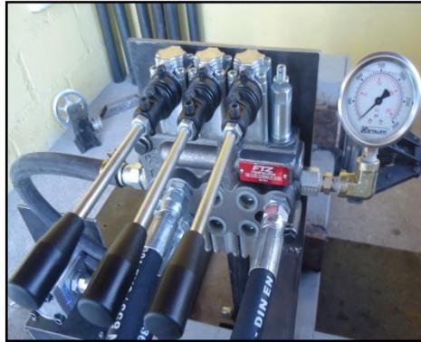
**Figura 137. Fijación del monoblock**
