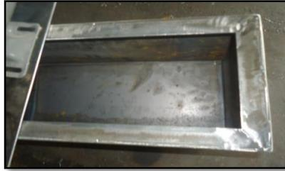
**Figura 134. Depósito hidráulico**
