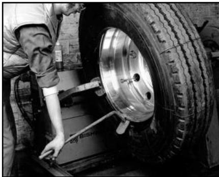
**Figura 4. Montaje del neumático**
