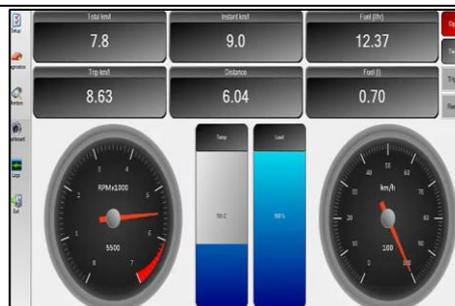
Comparar las revoluciones del OBDWIZ con las revoluciones del Software BLAHA para seguridad de una ensayo dinamómetro correcto.
