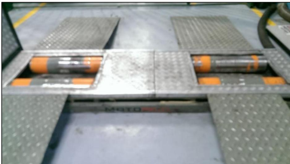
**Figura 17: Dinamómetro de rodillos Motorroll.**
