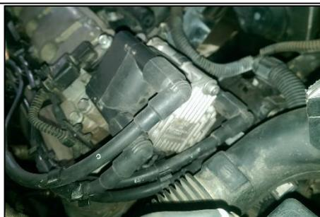
Conectar la pinza de voltaje al cable de bujías del primer cilindro, para obtener el oscilograma secundario.
