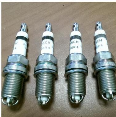
**Figura 26: Juego de bujías Bosch 4 electrodos**
