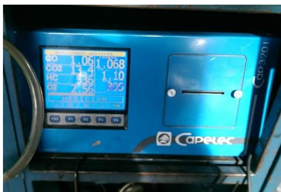
Figura 23: Analizador de gases Capelec en funcionamiento.
