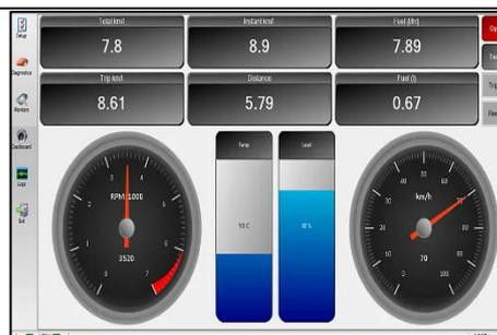
Cuando se realiza la prueba dinamoétrica se puede observar como va cambiando el consumo de combustible en relación al régimen de giro.
