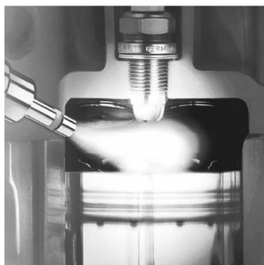
**Figura 4: Bujía de encendido en un motor a gasolina.**
