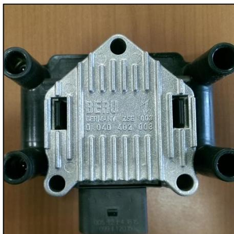
**Figura 33: Bobina de encendido Beru.**
