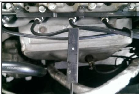
Encender el vehículo y conectar el filtro del analizador de gases.
