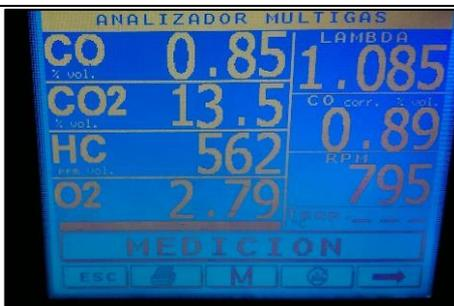
Observar en la pantalla del analizador los valores de los gases nocivos e hidrocarburos en ralentí.
