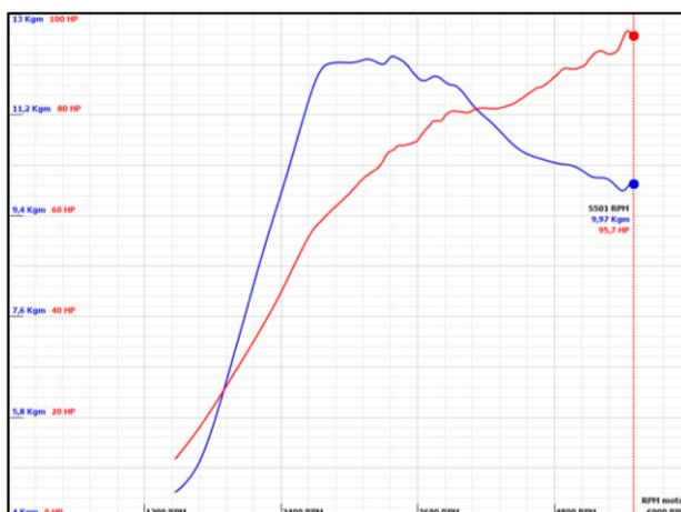
**Figura 59: Curvas de potencia y torque de la combinación 10.**
