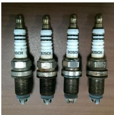
**Figura 24: Juego de bujías Bosch 3 electrodos.**
