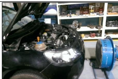
Verificar que el sensor de revoluciones esté funcionando correctamente girando manualmente los rodillos (luz indicadora).
