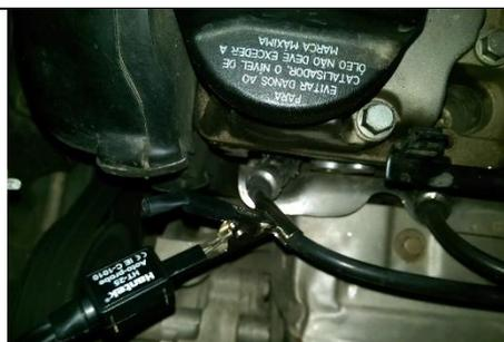
Realizar la conexión de masa al negativo de la batería para evitar posibles fallos o cortocircuitos de los cables.
