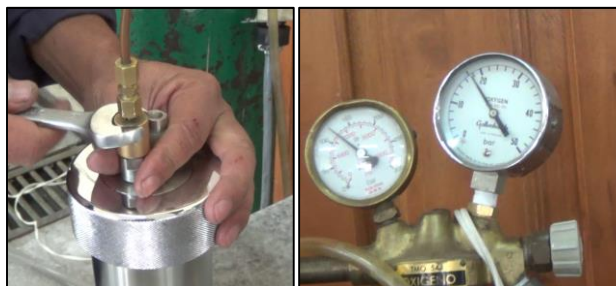
Figura 40: Presurización de bomba de calor.
