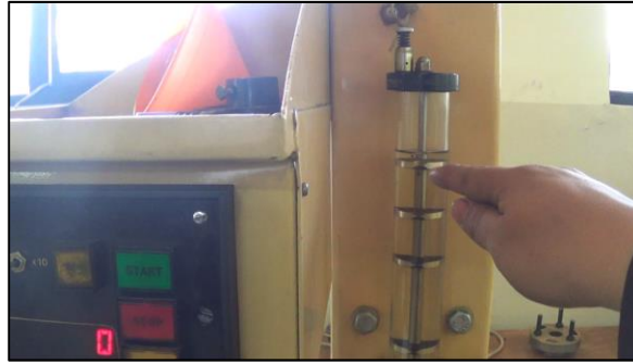
Figura 66: Medición de consumo de combustible.
