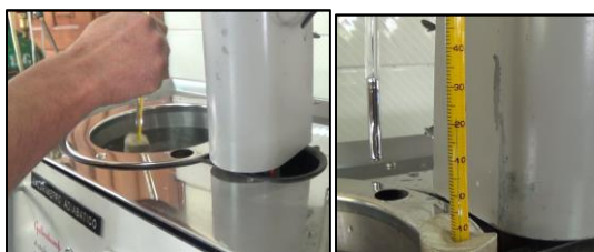
Figura 41: Revisión de temperatura de agua de camisa externa.
