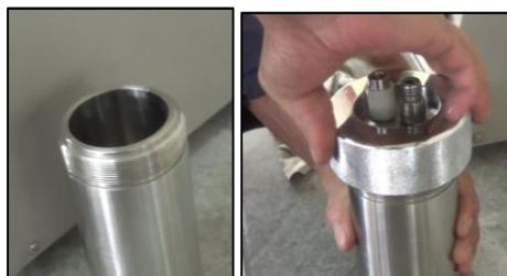
Figura 39: Armado de la bomba de calor.
