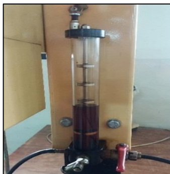
Figura 58: Medidor de muestra de diesel.
