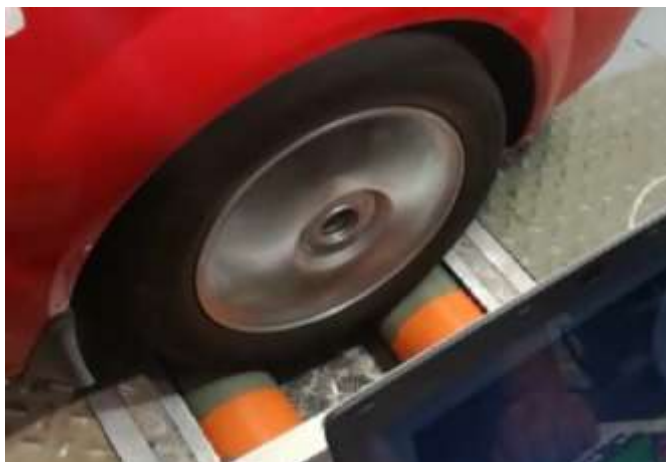
Figura 127 Colocación de las ruedas motrices en los rodillos del dinamómetro.
