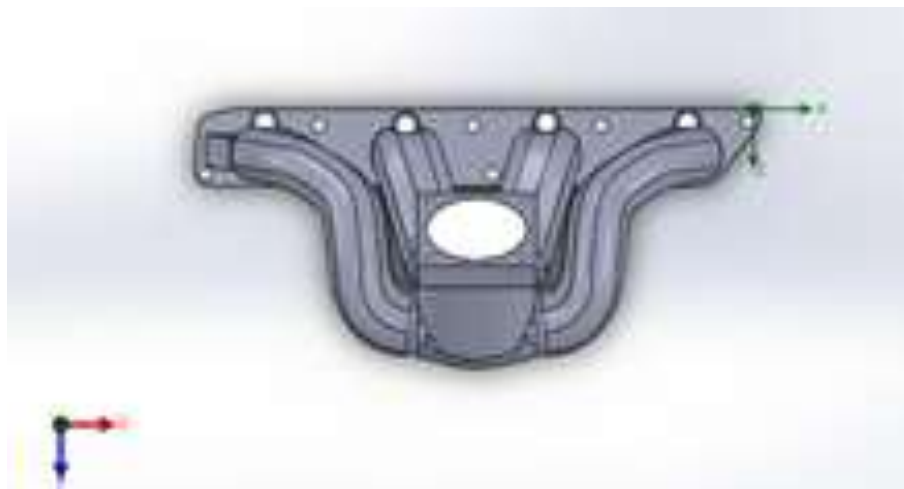
Figura 91 Vista Superior del múltiple rediseñado
