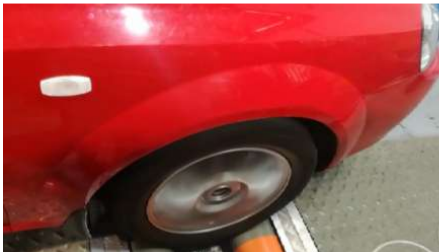
Figura 131 Conducción del vehículo en el dinamómetro
