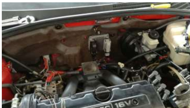
Figura 125 Instalación del Múltiple de admisión diseñado.
