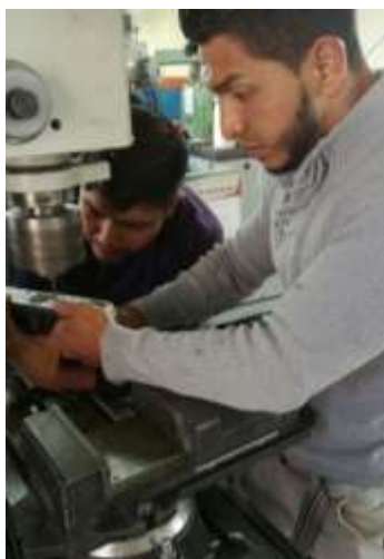
Figura 121 Ampliación del diámetro para los espárragos en la Brida.
