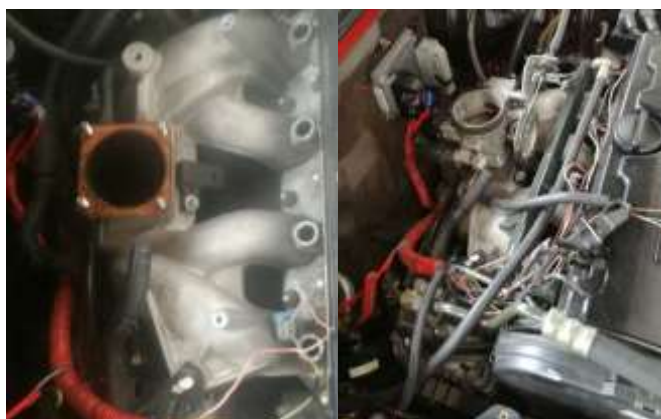
Figura 117 Desmontaje del Riel de Inyectores
