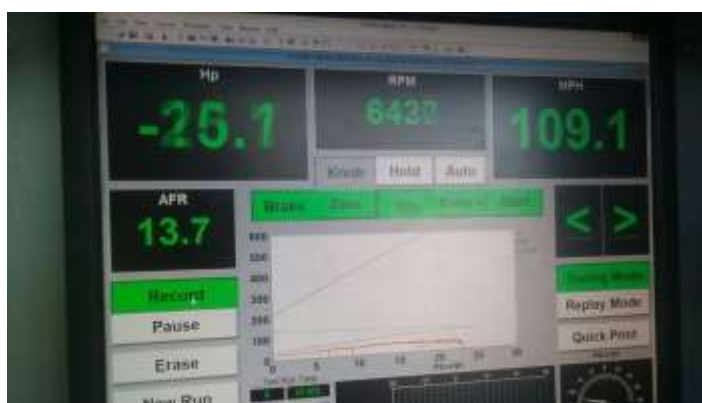
Figura 128 Computadora del dinamómetro, la cual muestra velocímetro y tacómetro.
