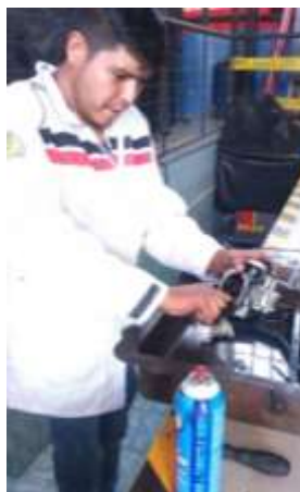
Figura 123 Limpieza del cuerpo de aceleración y válvula IAC.
