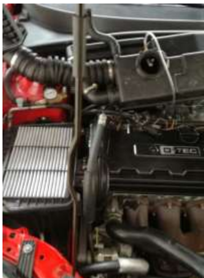
Figura 126 Instalación del depurador - filtro de aire.
