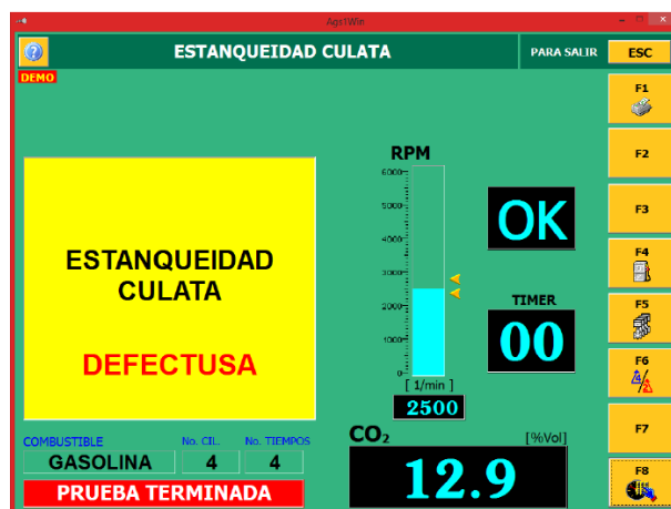
Figura 80. Final de la prueba de estanqueidad de junta de culata
