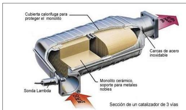
Figura 12. Convertidor Catalítico de Tres Vías, proceso de reacción
