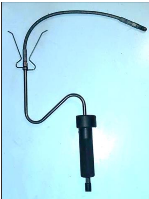
Figura 36. Sonda de extracción de gas
