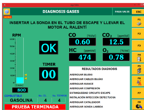
Figura 76. Diagnóstico de gases para vehículo catalizado
