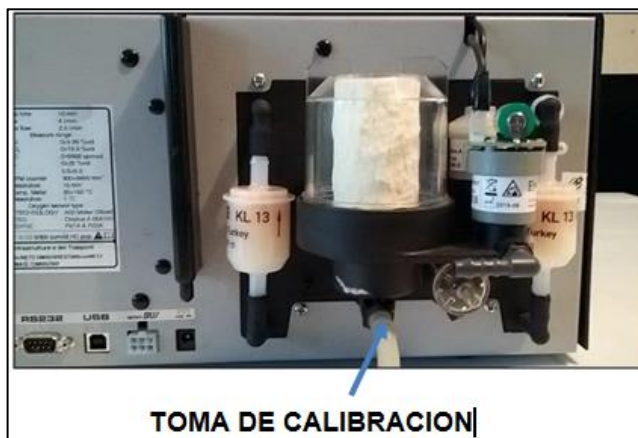
Figura 45. Toma de calibración
