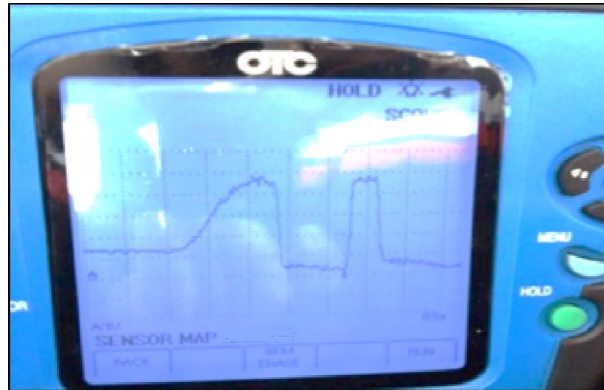
Figura 28. Forma de onda del Sensor MAP
