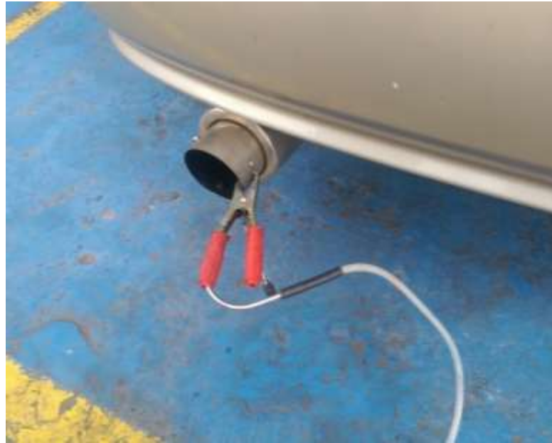
Figura 40: Conexión sonda de muestro del analizador de gases
