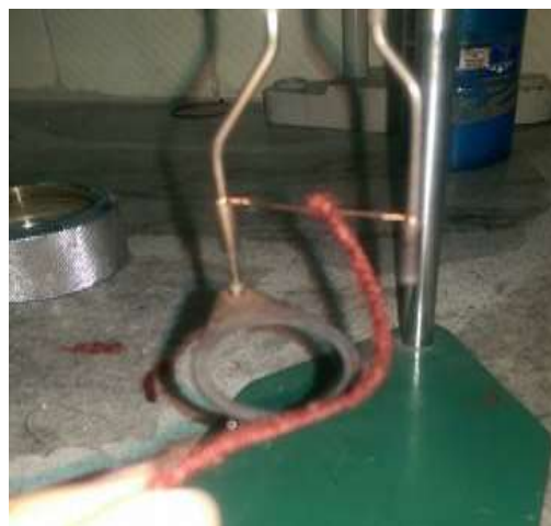
Figura 32: Cordel de combustión
