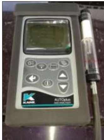
Figura 13: Analizador de gases AUTOplus KANE
