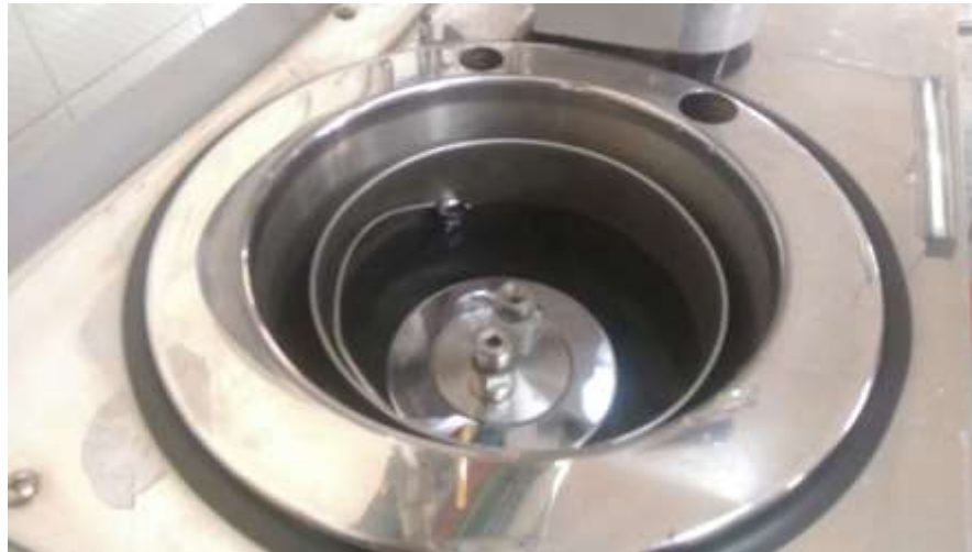
Figura 35: Bomba introducida para pruebas
