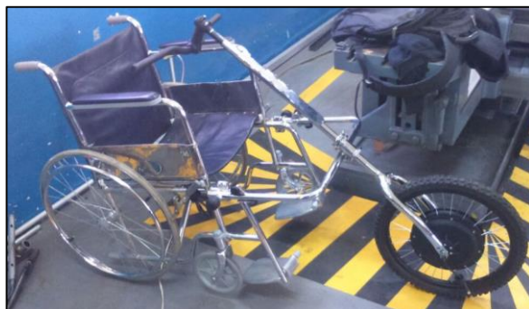
Figura 44 Montaje de la estructura a la silla de ruedas.
