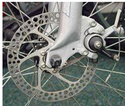
Figura 12 Freno de disco mecánico delantero
