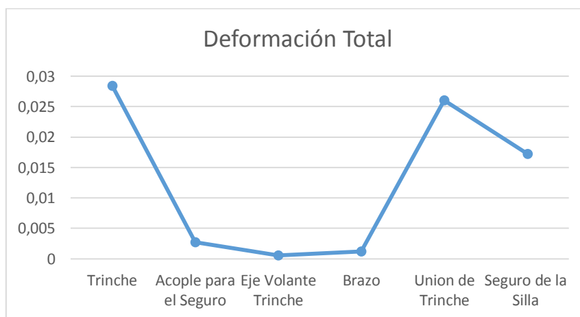
Figura 34 Datos de Deformación total del Monociclo
