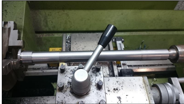
Figura 40 Maquinado del eje vertical.
