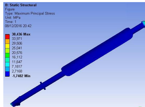
Ilustración 18: Análisis del Esfuerzo Principal Máximo del Eje Volante
