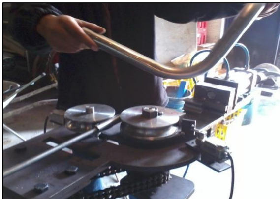
Figura 39 Doblado de los tubos a 90 grados.
