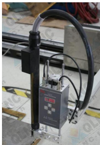
Figura 17: Control de altura SH-HC 30 Fuente: (Microstep, 2014)
