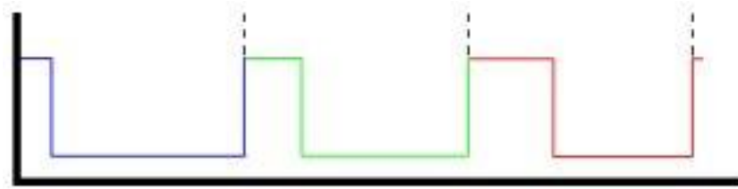
Figura 11: Generación de una Onda PWM
