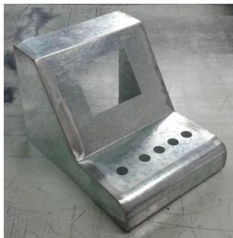
**Figura 34. Cubierta del panel de mando móvil**
