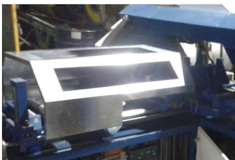
**Figura 64. Implementación de la cubierta protectora de seguridad**
