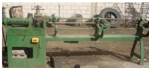
**Figura 5. Máquina trefiladora de varilla con mecanismo de corte implementado**
