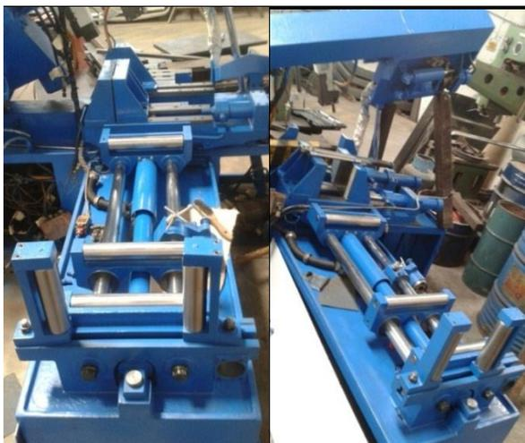
**Figura 58. Ensamble final de los elementos del sistema para posicionamiento de material**
