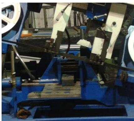
**Figura 22. Válvulas tipo bola para paso de refrigerante hacia la cinta durante el corte**
