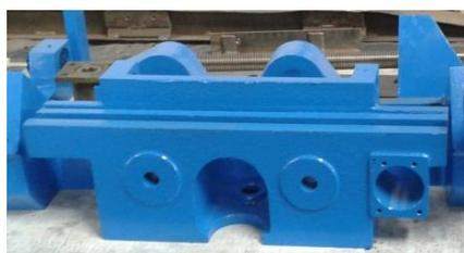
**Figura 52. Base centrador posterior del sistema**
