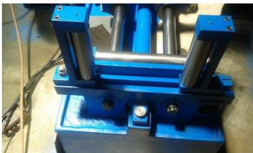
**Figura 65. Montaje de los topes reguladores de ancho en el sistema**
