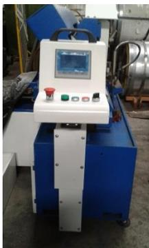
**Figura 40. Panel de mando móvil en posición 0°**
