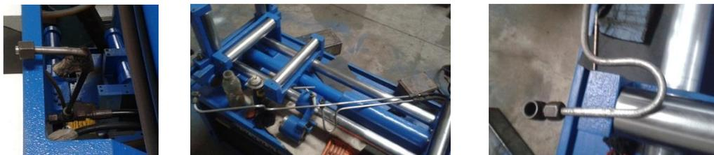
**Figura 68. Cañerías de los pistones hidráulicos de las mordazas**
