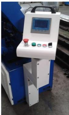
**Figura 39. Implementación del panel terminado con botoneras y la KTP 400 (HMI)**
