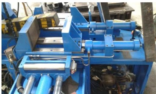
**Figura 55. Montaje de las mordazas de sujeción y los respectivos pistones hidráulicos**
