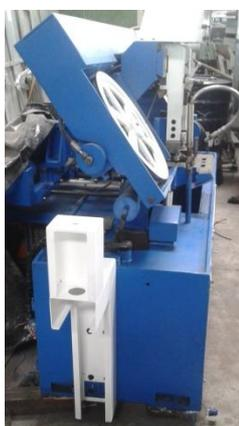
**Figura 37. Montaje del brazo base a la bancada**
