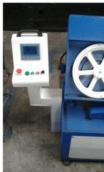
**Figura 42. Panel de mando móvil en posición +90°**
