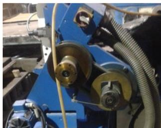
**Figura 82. Transmisión por banda**
