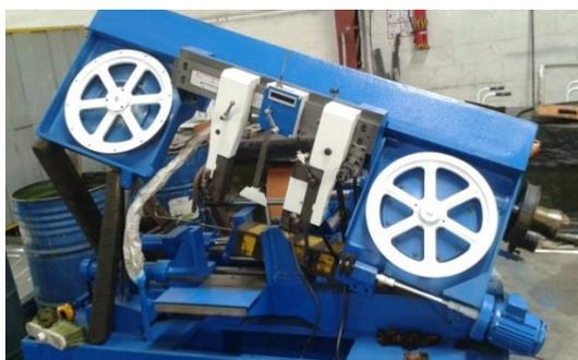
**Figura 49. Montaje y mantenimiento finalizados en el módulo de la sierra de cinta**
