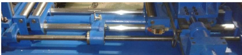
**Figura 70. Pistón de alimentación de material**
