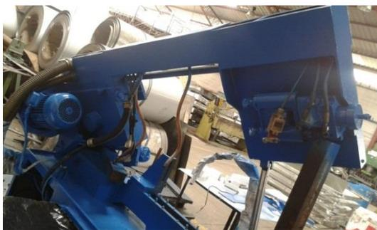
**Figura 46. Motor eléctrico y tensor hidráulico de la cinta de sierra**
