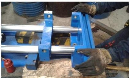
**Figura 53. Cilindros guías y base del rodillo intermedio**
