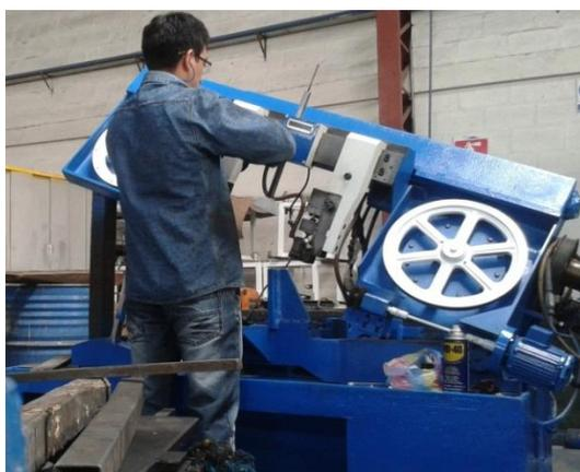
**Figura 48. Montaje de los elementos del módulo de la sierra**
