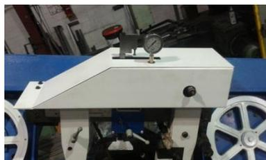
**Figura 76. Montaje completo de la base de la válvula reguladora de presión de corte**
