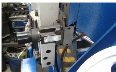
**Figura 75. Perilla reguladora de la presión de corte**
