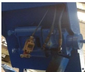
**Figura 73. Pistón del tensor de la cinta**
