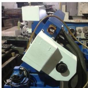
**Figura 83. Cubierta de seguridad de la transmisión por banda**
