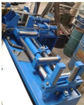
**Figura 60. Disposición de los rodillos de rodadura**
