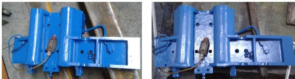
**Figura 50. Mesa alimentadora del sistema para posicionamiento y corte**
