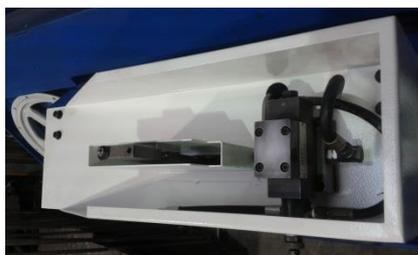
**Figura 74. Parte interna de la base soporte de la válvula de regulación de la presión de corte**
