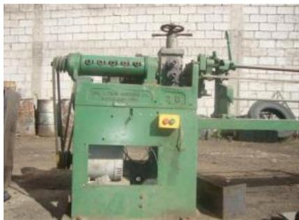
**Figura 4. Máquina trefiladora de varilla**
