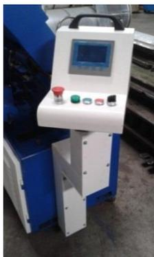
**Figura 94.** Panel de mando móvil implementado y montado
