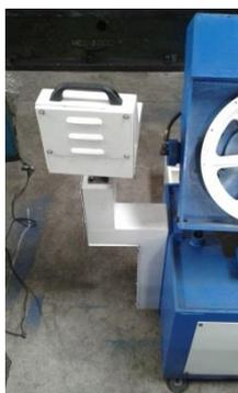
**Figura 41. Panel de mando móvil en posición -90°**
