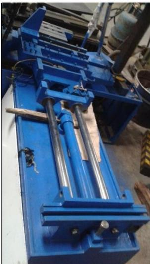
**Figura 54. Montaje del pistón, mesa, base centradora posterior, base rodillo y cilindros guías en la bancada**
