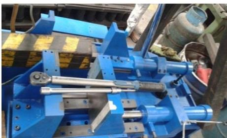
**Figura 56. Ajuste de pernos de los elementos de sujeción de material**
