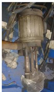
**Figura 79. Bomba del sistema de refrigeración**
