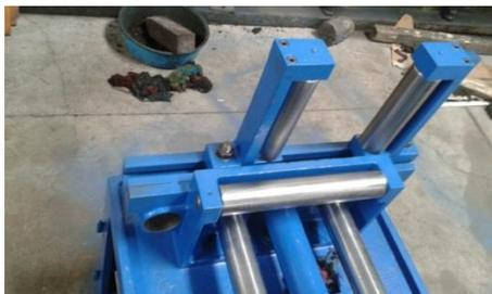
**Figura 57. Montaje de rodillos en el sistema**
