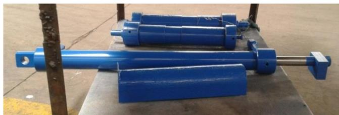
**Figura 51. Pistones hidráulicos (mordazas y mesa) del sistema**
