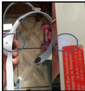
Figura 157. Sensor y USB MindWave con conexión
