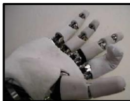
Figura 4. Diseño de mano Robonaut
