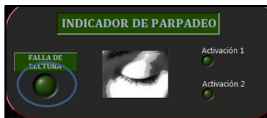
Figura 154. Alarma óptica de falla de lectura
