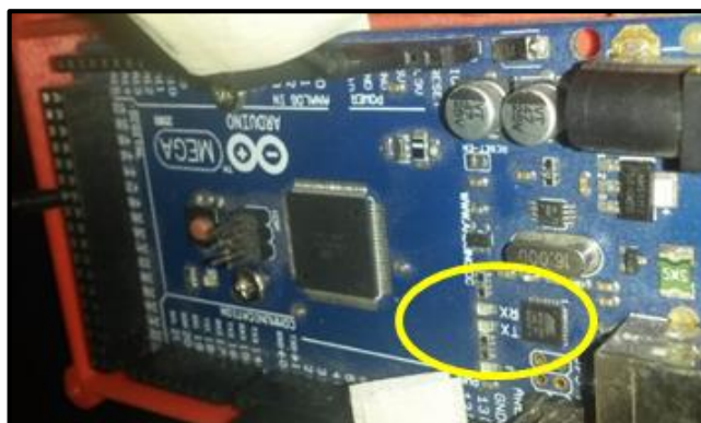
Figura 160. Arduino mega RX y TX apagados sin conexión
