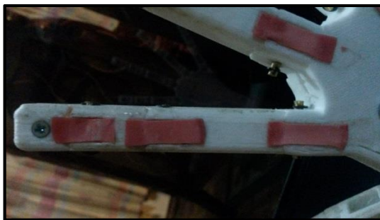
Figura 105. Colocación de bandas elásticas
