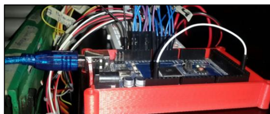
Figura 146. Puertos de salida en la placa de control
