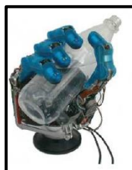
Figura 3. Diseño de mano DLR
