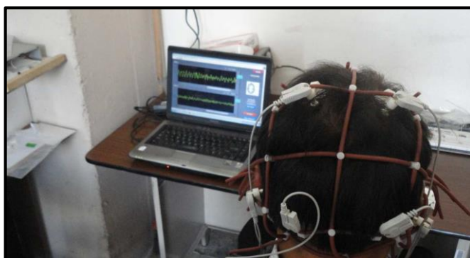
Figura 23. Posición de sensores para la adquisición de señales
