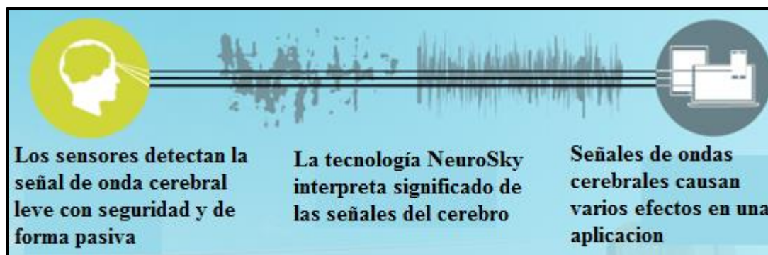
Figura 33. Funcionamiento del lector MindWave de NeuroSky
