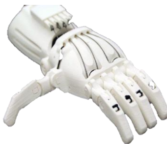
Figura 28. Prótesis de mano elaborada a partir de impresión 3D.
