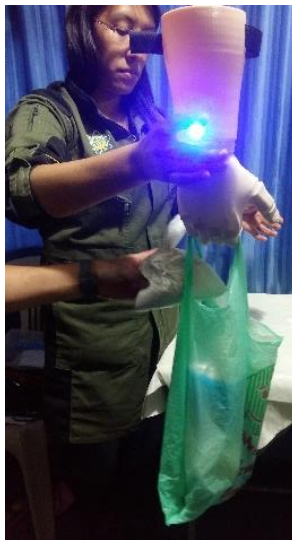
Figura 89. Pruebas de agarre en gancho con adición de pesos.
