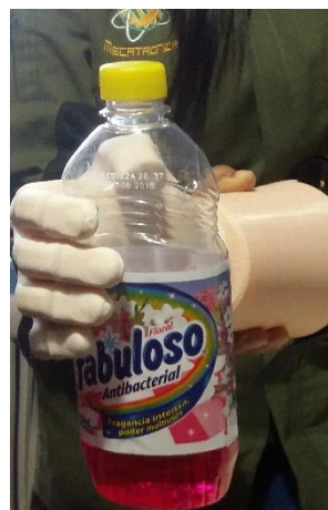
Figura 85. Objetos para pruebas de agarre cilíndrico.
