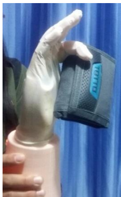
Figura 91. Prueba de agarre en pinza con distintos objetos.
