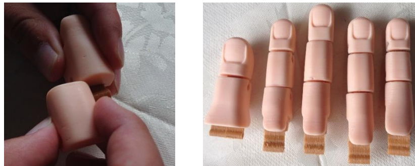
Figura 77. Ensamble de los dedos con articulaciones.
