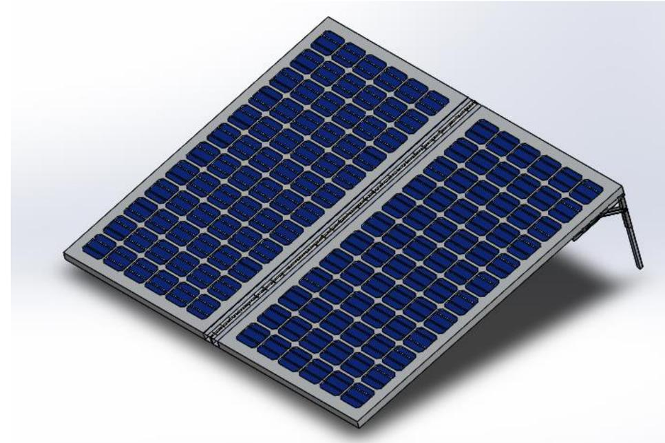
Diseño para realizar pruebas en Desierto de Atacama a 15°.
