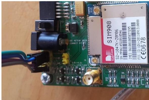
**Figura 89.** Interfaz TTL para la comunicación.
