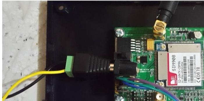
**Figura 88.** Alimentación de la tarjeta SIM908
