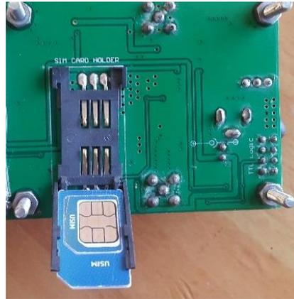
**Figura 85.** Colocación del Chip.
