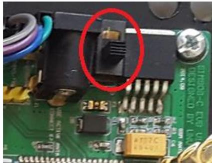
**Figura 86.** Posición de encendido del switch.
