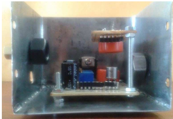
Figura 15. Cámara de sensores acoplado los circuitos PCBs
