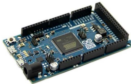
Figura 23. Tarjeta Arduino DUE Autor: (Cetronic, s.f.)
