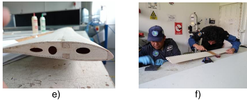
Figura 89. Construcción, a) Impresión 3D costillas, b) corte láser costillas, c) posición de largueros y costillas, d) recubriendo de balsa, e) lijado y colocación de borde de ataque, f) recubrimiento con fibra de vidrio.
