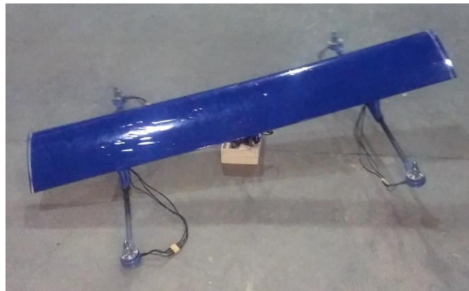
Figura 93. Prueba de calibración de los ESC
