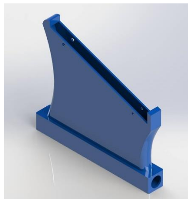
Figura 70. Acople entre ala y brazo de multi rotor.
