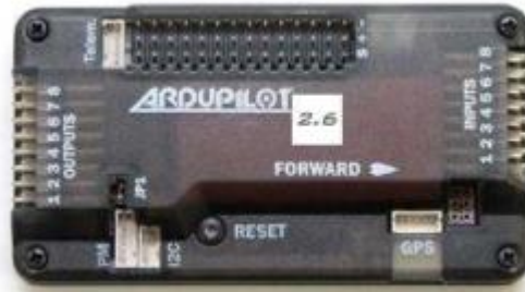
Figura 35. Ardupilot APM 2.6. Fuente: (Figueiredo, 2014)
