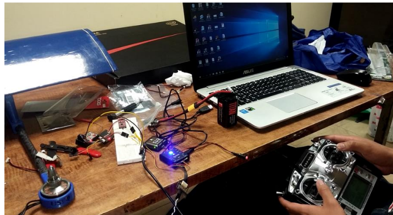
Figura 92. Control de velocidad de motor a través de señales PWM del autopiloto Pixhawk Mini
