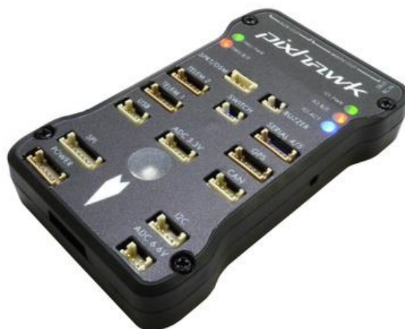
Figura 36. Autopiloto Pixhawk Fuente: (Figueiredo, 2014)
