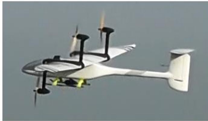
Figura 2. VTOL SONGBIRD 1500 V1 con rotores en posición horizontal para vuelo. Fuente: (Mönninghof et al., 2015)
