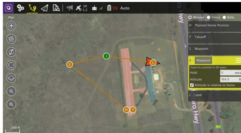
Figura 84. Misión planificada en QGroundControl V3.0.2
