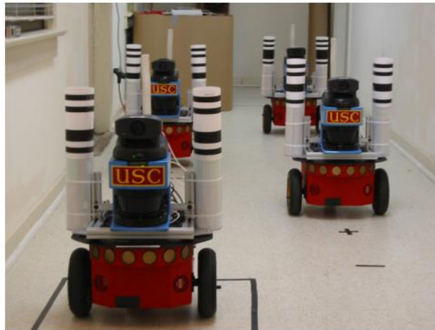
Figura 13. Robots móviles utilizados por Howard, (2006) con torres codificadas para su identificación autónoma.
