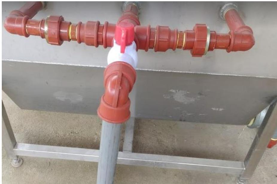
**Figura 61. Tubería que alimenta a los eductores.**
