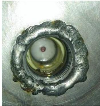
**Figura 57. Perforación de la estructura y visor para el sensor.**
