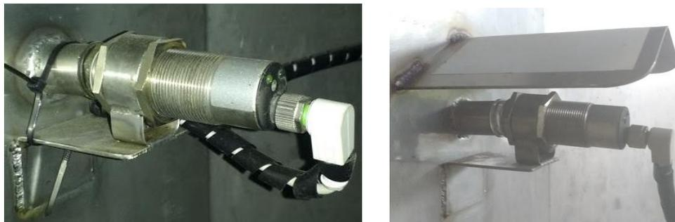
**Figura 58. Sensor capacitivo para el nivel de la tina de inmersión.**
