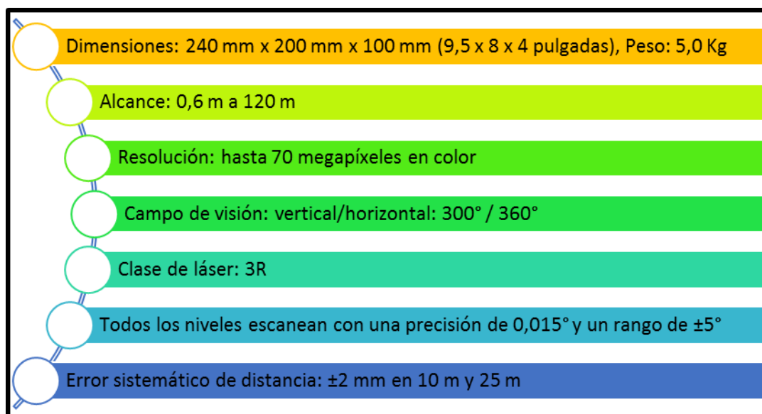
Figura 13: Características de Trimble TXD 3D Láser Scanner
