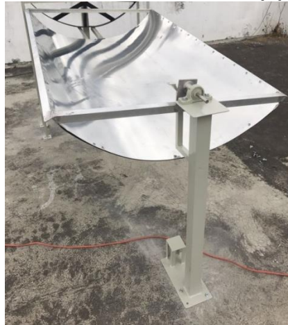
(c) Base reflectora colocada Figura 61 CCP construido
