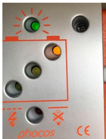
Figura 107 LED de estado la carga encendido
