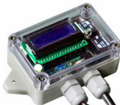
Figura 68 Caja del controlador del seguidor solar
