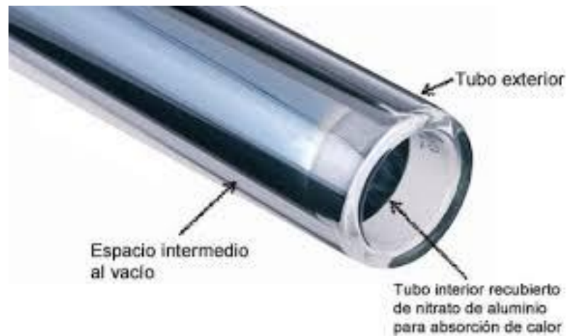
Figura 22 Tubo de vidrio sellado al vacío
