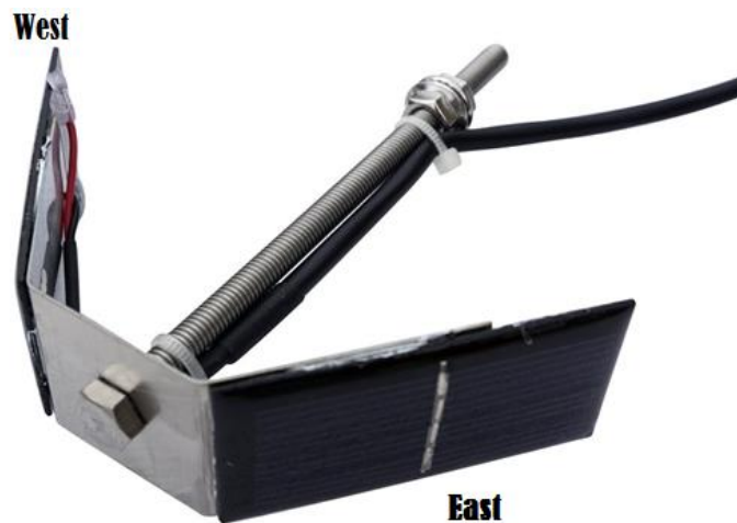
Figura 66 Celdas fotovoltaicas del seguidor solar
