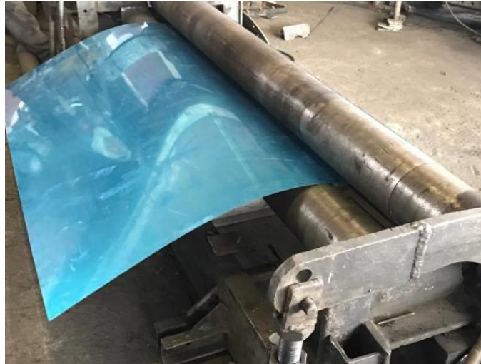
Figura 41 Plancha de aluminio en proceso de rolado
