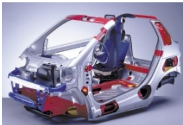
Figura 3 Carrocería auto portante de Smart car fortwo
