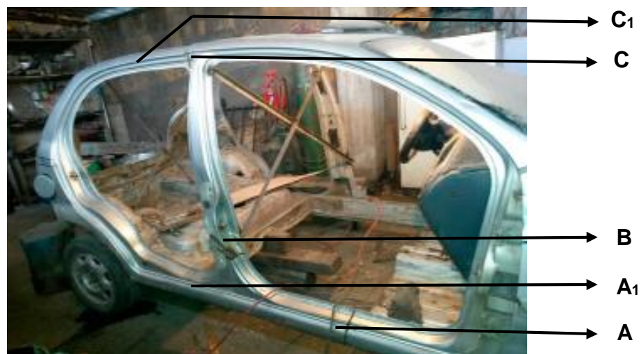
Figura 44 Descripción de los estribos y parantes seccionados
