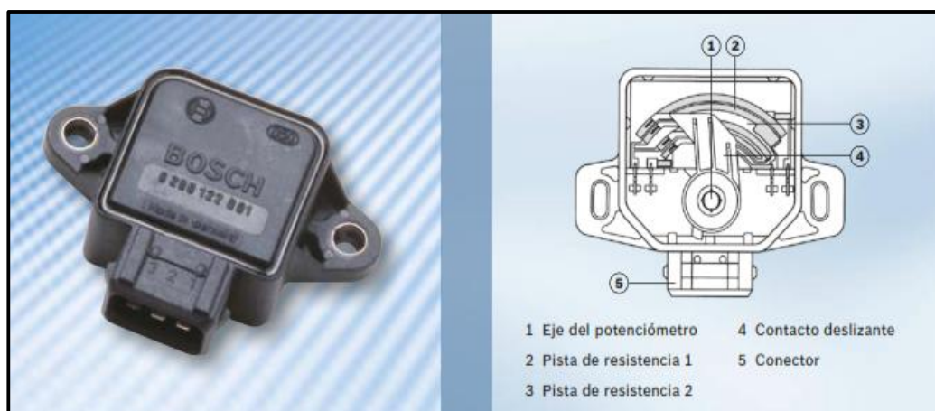
Figura 34 Sensor de posición del acelerador (TPS)
