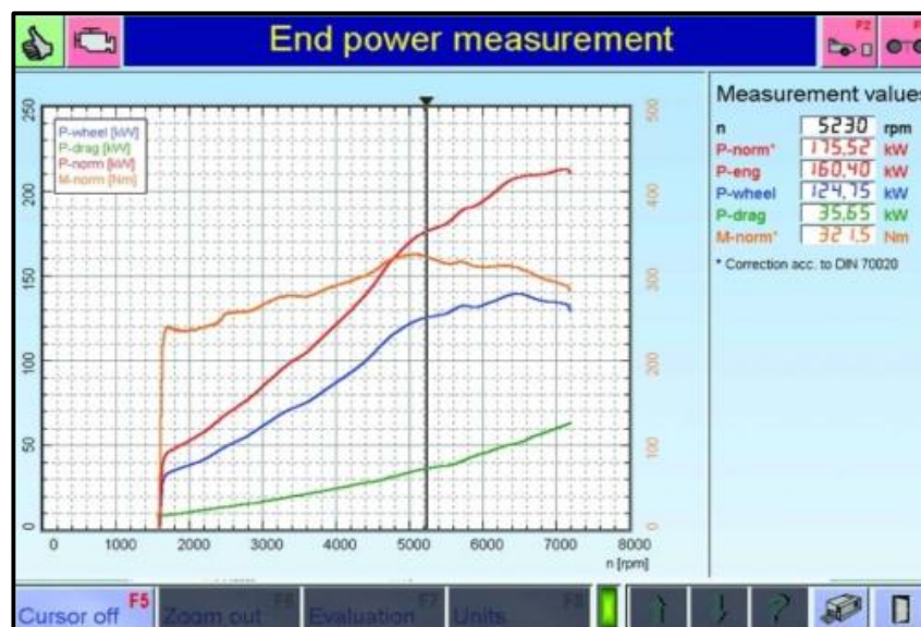
Figura 47 Curvas de torque y potencia dinamómetro LPS 3000
