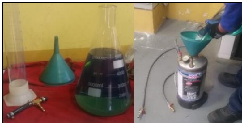
Figura 56 Equipos de consumo de combustible
