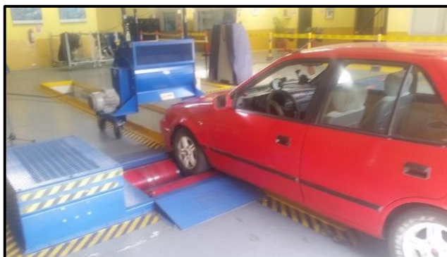
Figura 43 Vehículo en dinamómetro LPS 3000 MAHA
