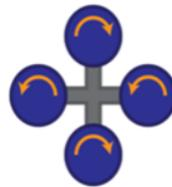
El cuadricóptero flota o ajusta su altura mediante la aplicación del mismo empuje a los cuatro rotores
