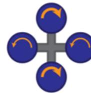
El cuadricóptero ajusta su orientación mediante la aplicación de más empuje a los rotores que giran en una misma dirección
