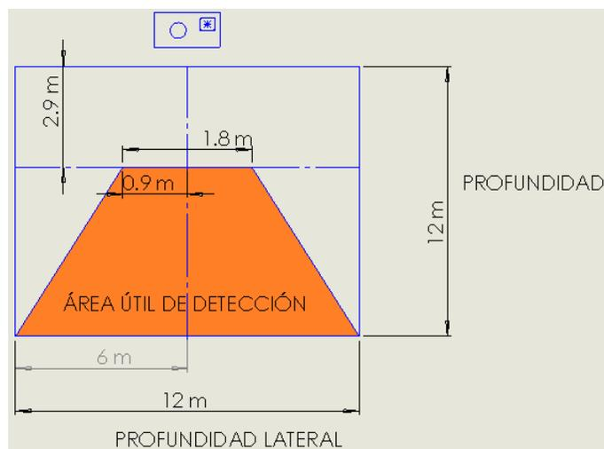
**Figura 46. Área de detección de la cámara estática**
