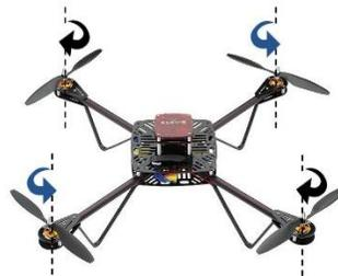
**Figura 5. Reacción de torques en cada motor de un Cuadricóptero**
