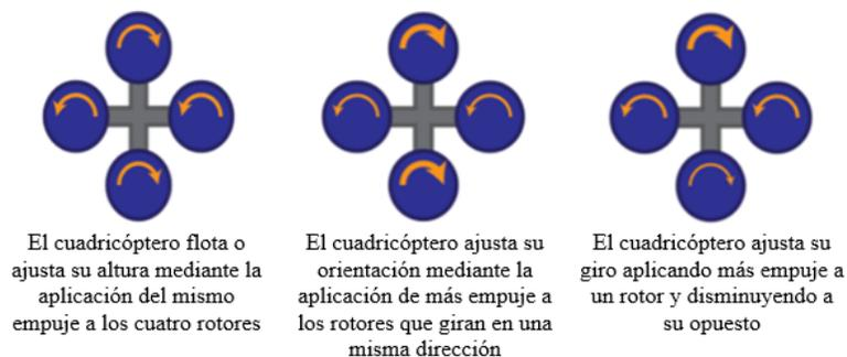
**Figura 6. Compensación de reacciones de torques de un Cuadricóptero**
