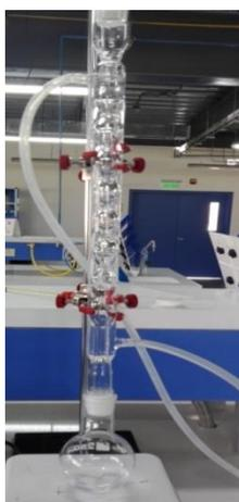
**Figura 11. Sistema para la preparación de metóxido de sodio**
