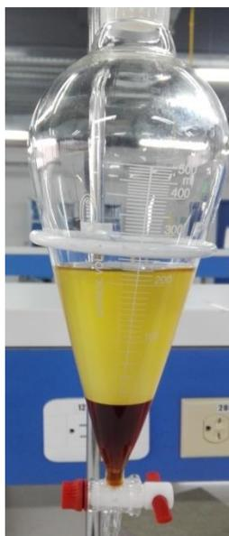
**Figura 12. Separación de fases ricas en glicerina y biodiesel**
