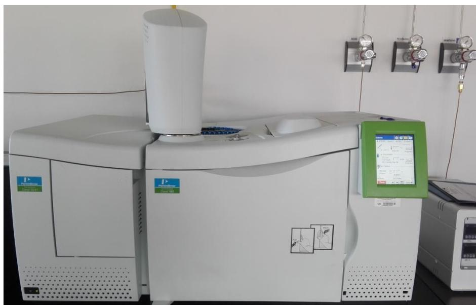
**Figura 17. Cromatógrafo de gases acoplado al espectrómetro de masas (GC/MS)**
