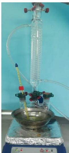
**Figura 7. Reactor empleado para la síntesis del biodiesel de “referencia”**
