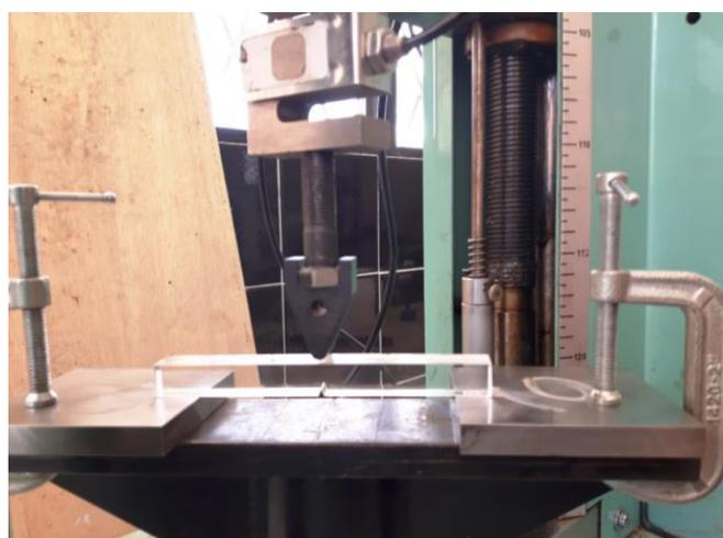
**Figura 152.** Ensayo de flexión en probetas de acrílico.
