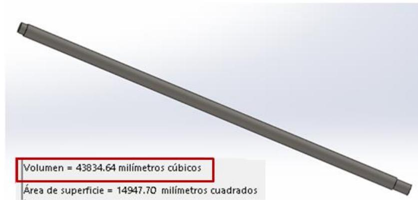
**Figura 75.** Propiedades físicas del brazo del eje
