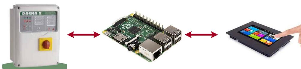
**Figura 51.** Panel de Control+Microcontrolador y tarjeta electrónica + Pantalla HMI
