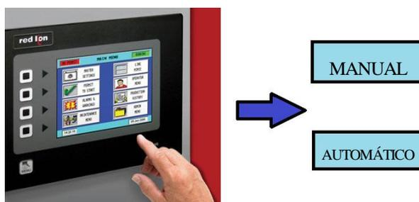
**Figura 13.** Selección del modo de operación mediante pantalla táctil
