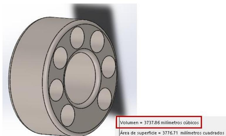
**Figura 76.** Volumen elemento para sujeción del brazo del péndulo
