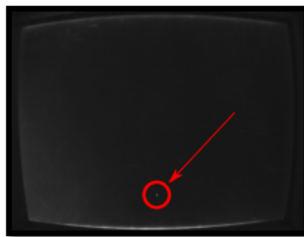
Figura 24. "Punto caliente" reflejado en la pantalla y adquirido por la cámara. Fuente: (Holzammer & Hahne, 2009).
