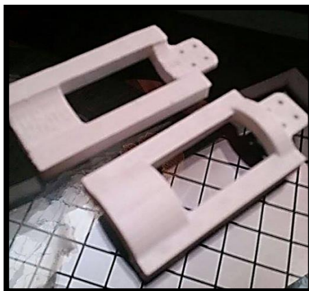
Figura 215. Dedos del efector final impresos en 3D
