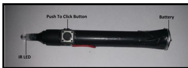
Figura 14. Stylus con IR nótese el botón que activa la luz IR.
