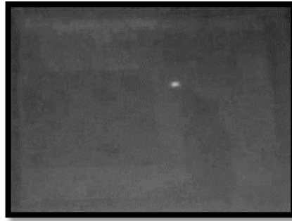
Figura 23. Pantalla convertida de RGB a escala de grises detectando al stylus con luz infrarroja.
