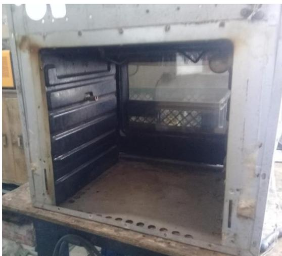
**Figura 99: Carcasa externa reciclable de un horno eléctrico adaptado al sistema de incubación.**
