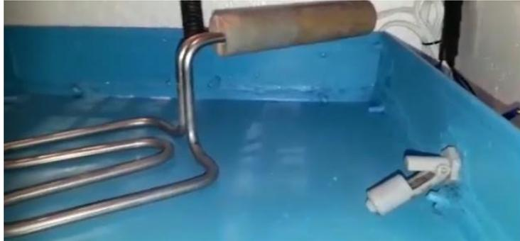
**Figura 113: Instalación de la resistencia para generar la humedad**
