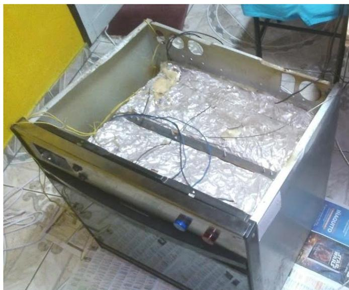
**Figura 100: Estructura implementada con aislante de lana de vidrio**
