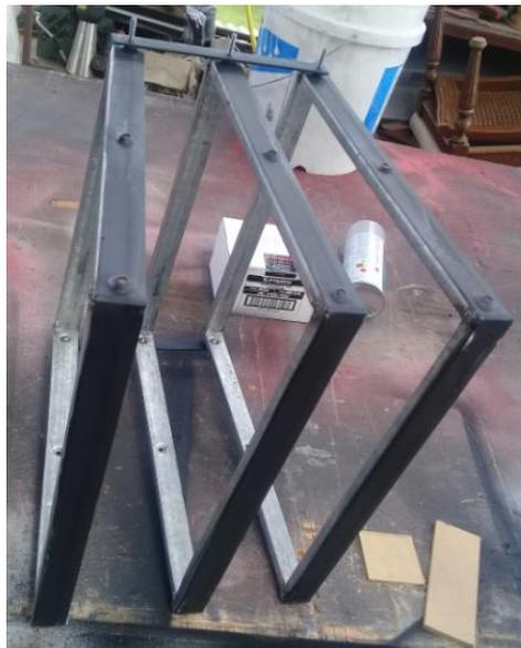
**Figura 101: Elaboración de los soportes para las bandejas en el sistema de volteo**
