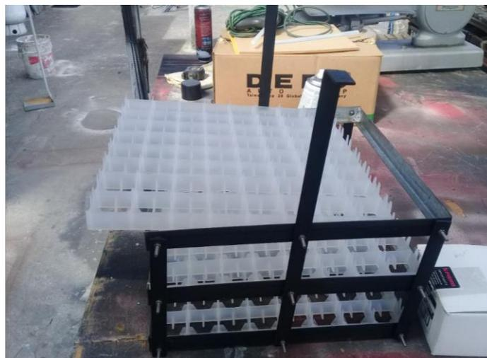
**Figura 102: Montaje de bandejas sobre el sistema de volteo**
