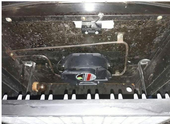
**Figura 112: Instalación del ventilador y resistencia calorífica**
