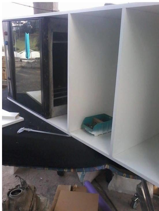
**Figura 110: Acople con la carcasa que contiene las bandejas y la repisa**
