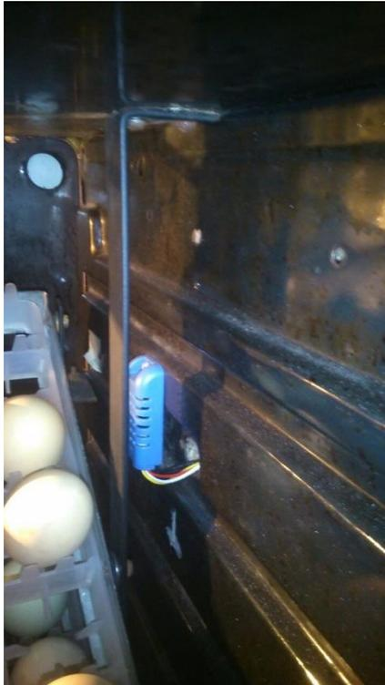
**Figura 105: Instalación del sensor de humedad**
