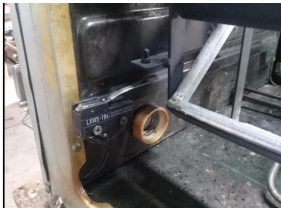
**Figura 104: Instalación de los fines de carrera del sistema de volteo**
