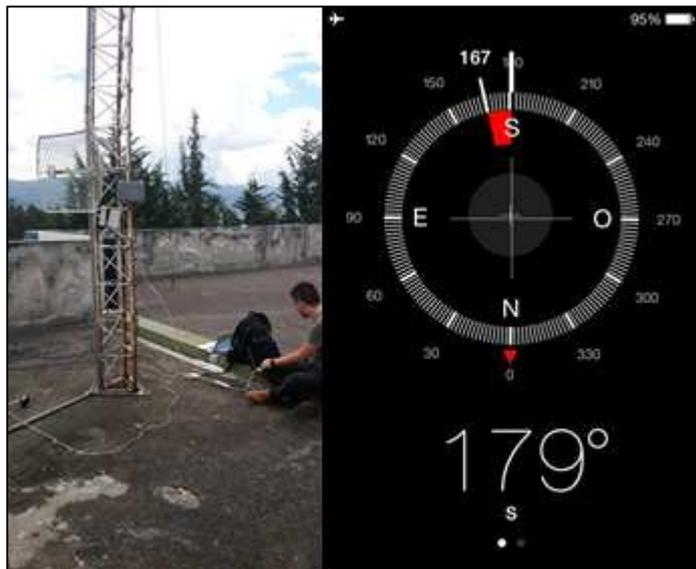
**Figura 34: Dirección de la antena de Recepción**
