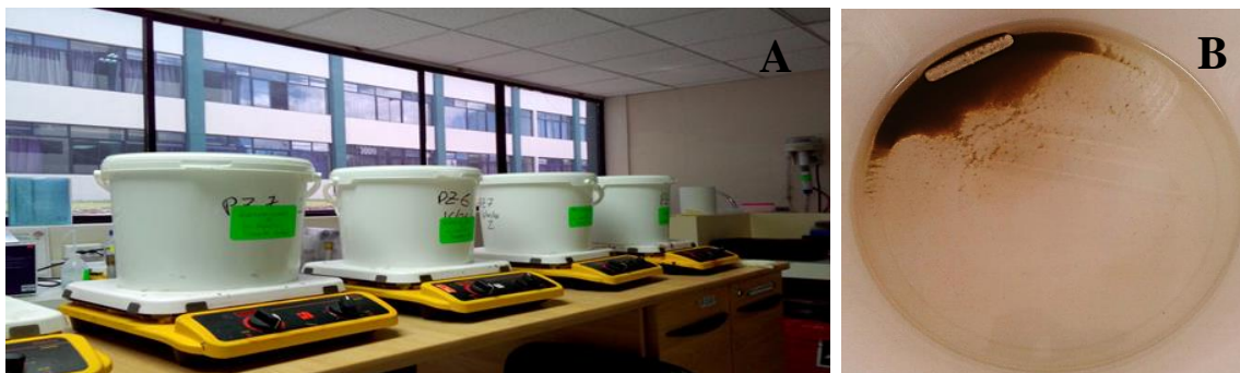
Figura 10. Concentración viral con el método de Leche Descremada (Skimmed Milk) A) Muestras en agitación. B) Flóculo formado después de decantación.
