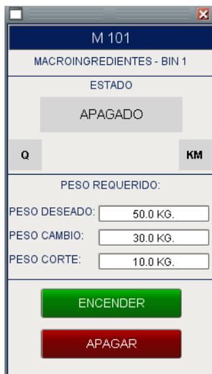
**Figura 93. Pop-up Control de Motores Dosificadores**
