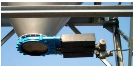
**Figura 12. Descarga por gravedad.**
