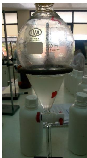
Figura 11. Embudo de separación para extraer grasa
