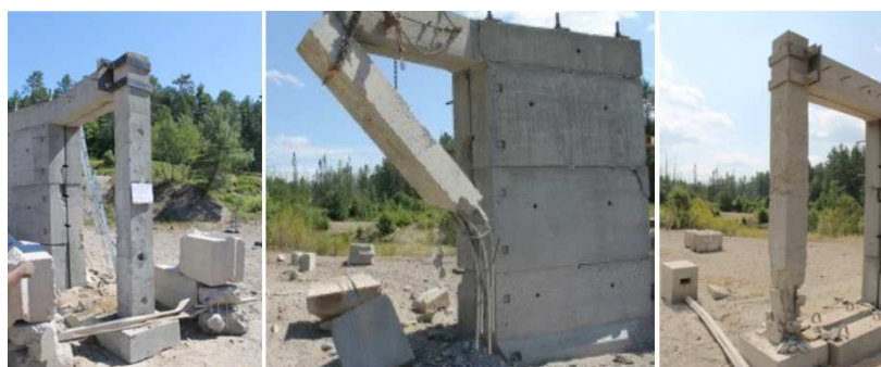
Figura 7 Ensayos destructivos realizados en elementos tipo Columna HA. Fuente: (Siba, 2014)
