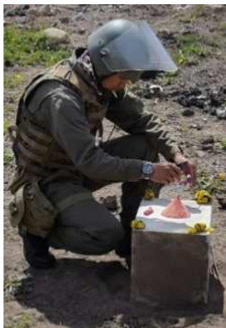
Figura 47 Cebamiento de cargas explosivas en probetas piloto
