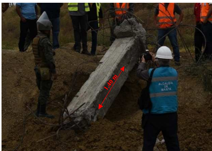
Figura 30 Disposición de probeta de ensayo, Manabí
