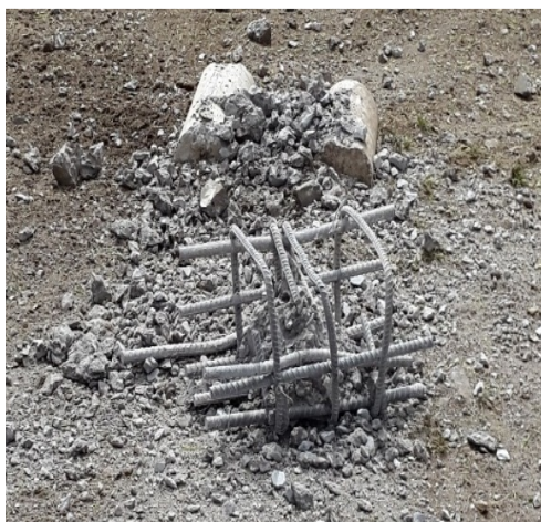
Figura 48 Probeta piloto, posterior al ensayo experimental destructivo
