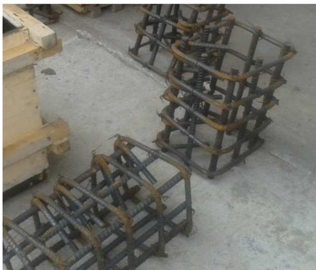
Figura 38 Acero de refuerzo para probetas piloto de hormigón armado
