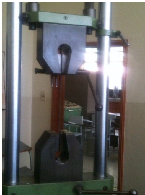
Figura 90 Ensayo de tracción en varillas corrugadas.
