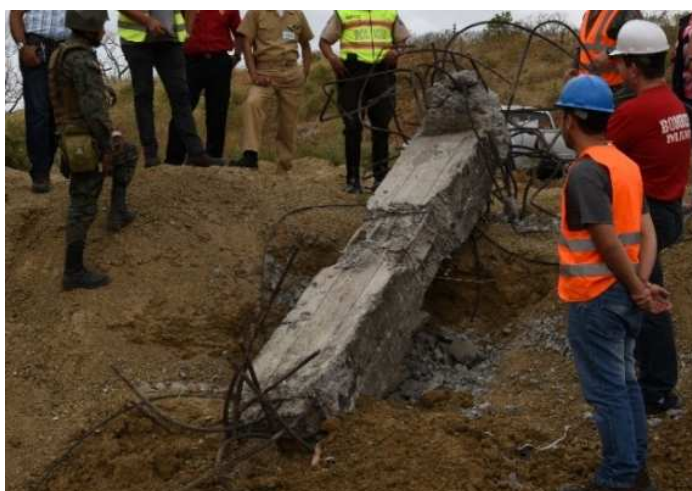
Figura 32 Probeta tipo columna post-ensayo, Manabí
