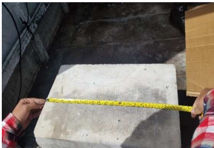
Figura 43 Toma de datos previo a la ejecución de los ensayos destructivos
