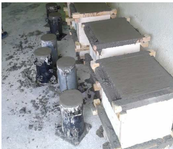
Figura 40 Probetas piloto HA y cilindro posterior a la fundición
