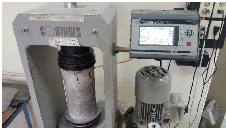
Figura 42 Ensayo de compresión en cilindros de hormigón
