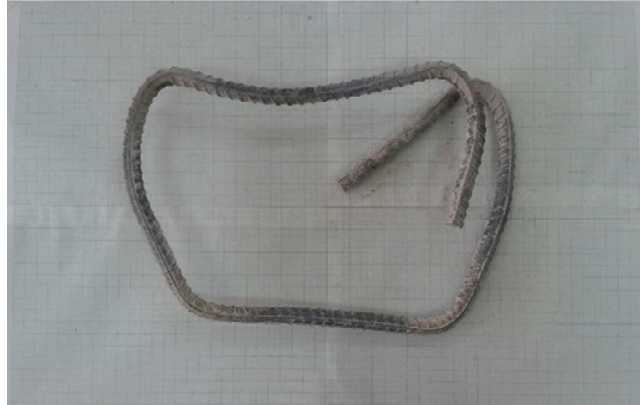
Figura 89 Estribo deformado post ensayo, Probetas Piloto HA.
