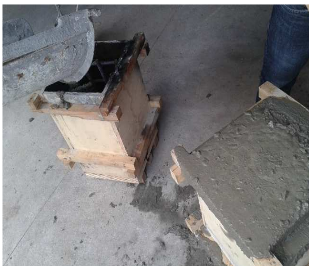
Figura 39 Fundición de probetas piloto de hormigón armado
