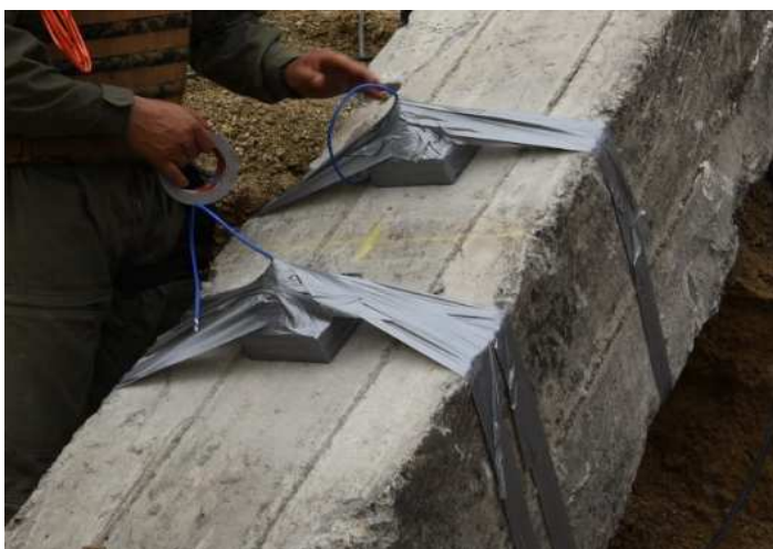
Figura 31 Instalación de cargas explosivas en probetas de ensayo, Manabí
