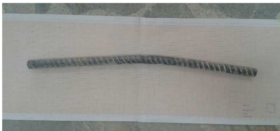
Figura 88 Acero longitudinal deformado, Probetas Piloto HA.
