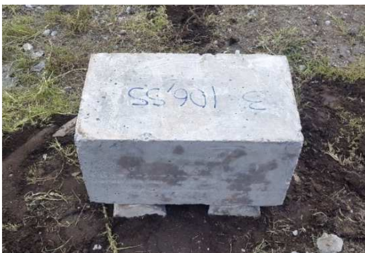
Figura 44 Probeta simplemente apoyada sobre cilindros de hormigón
