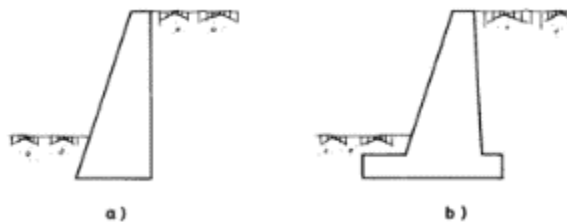
Figura 35 Muro de gravedad
