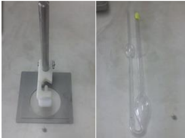
Figura No. 43. Sujetador y viscosímetro Ostwald
