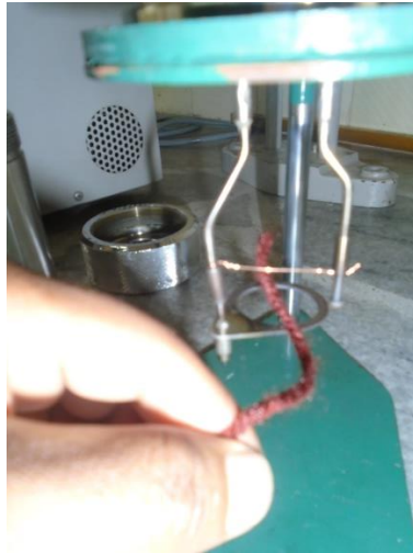
Figura No. 37. Instalación del mechero
