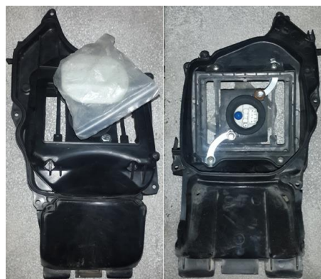
Figura 41. Tapa secundaria del depósito con el sistema de sujeción de la bomba. (Desde la izq. vista posterior de la tapa y vista frontal de la tapa con la bomba ya ubicada.)
