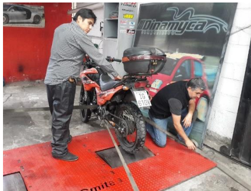
Figura 78. Colocación de correas de seguridad para la moto en el dinamómetro
