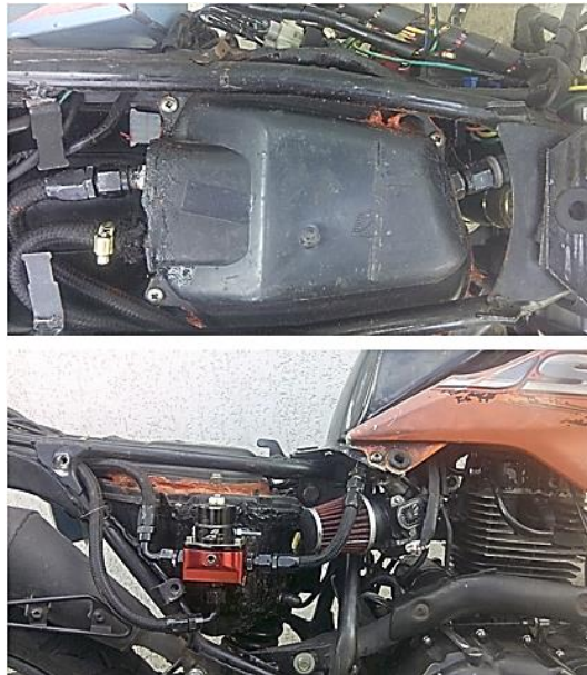
Figura 44. Sistema de alimentación de combustible instalado en la motocicleta (Vista superior y Vista lateral)
