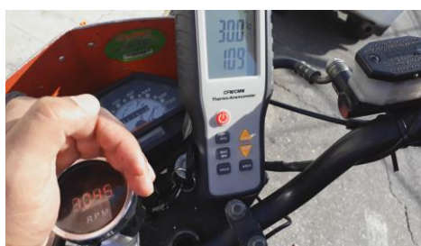
Figura 31. Medición de la velocidad del aire al ingreso de la admisión.
