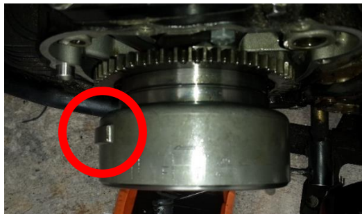
Figura 45. Diente en el volante magnético que activa el sensor CKP
