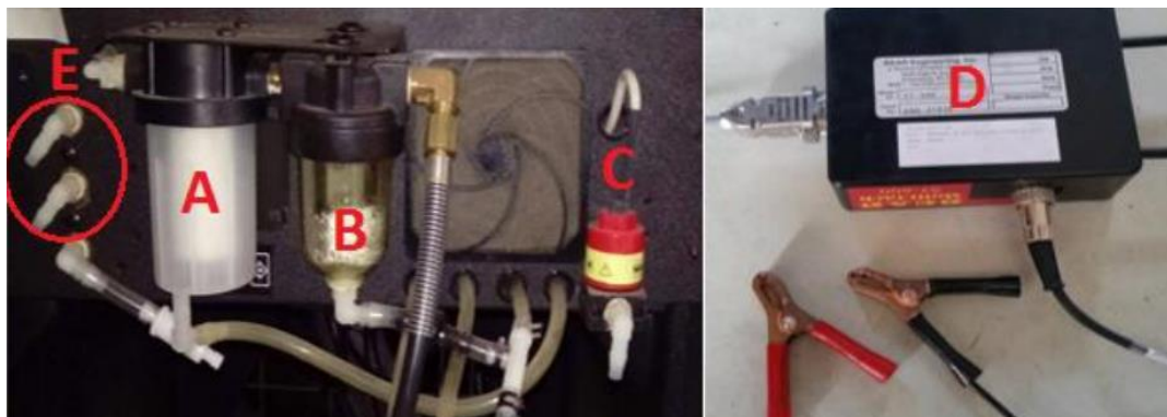
Figura 25. Partes que conforman el equipo CARTEK modelo 50-100 Fuente: (Chiliquinga Bustos & Ruiz Ruiz, 2016)
