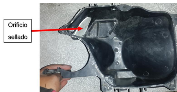
Figura 40. Depósito de combustible secundario
