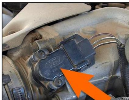
**Figura 11. Sensor de posición de la mariposa de aceleración TPS**
