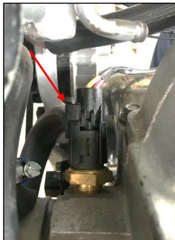
**Figura 33. Sensor ECT del motor Ford**
