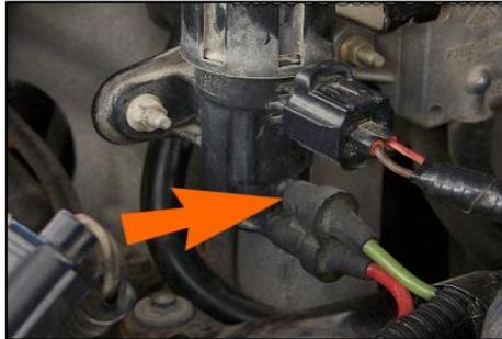
**Figura 22. Válvula de recirculación de gases de escape EGR**
