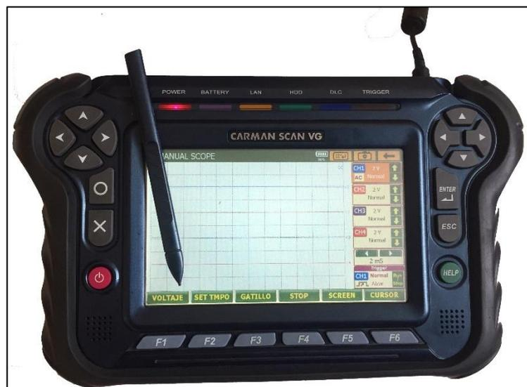
Figura 47. Osciloscopio en el escáner Carman Scan VG64
