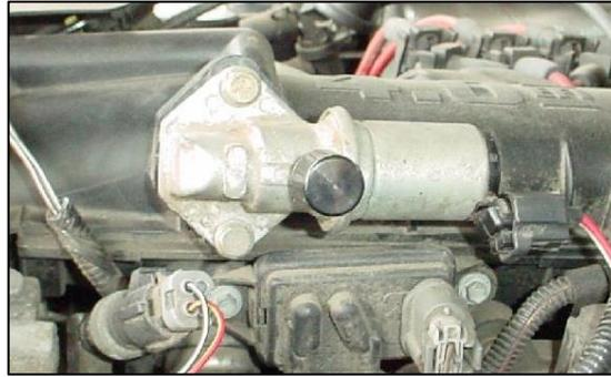
**Figura 20. Válvula de control de aire en ralentí IAC**
