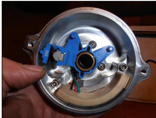
**Figura 13. Sensor de captación del perfil de ignición PIP**
