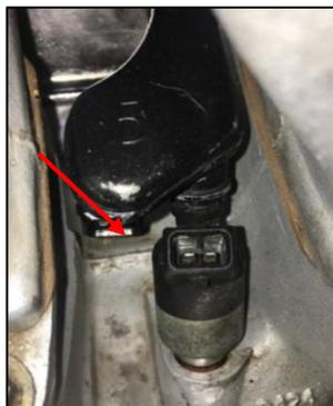
Figura 41. Inyector del motor Ford
