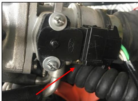
**Figura 35. Sensor TPS del motor Ford**
