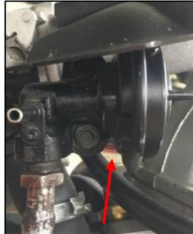
Figura 42. Recirculación de gases de escape EGR
