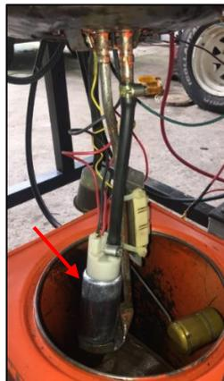
Figura 39. Bomba eléctrica de combustible del motor Ford
