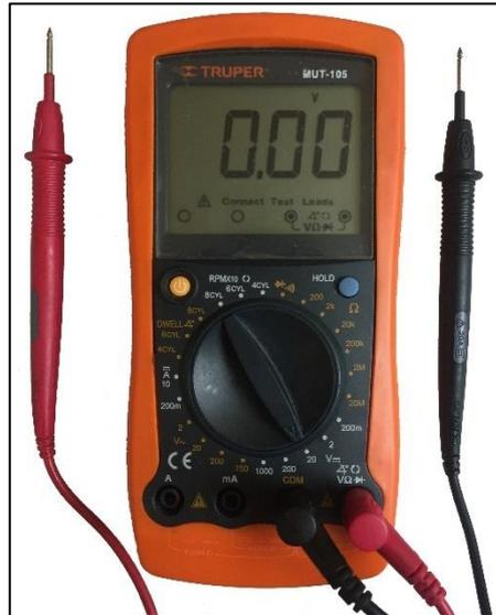
**Figura 45. Multímetro automotriz**
