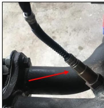
**Figura 37. Sensor de oxígeno del motor Ford**
