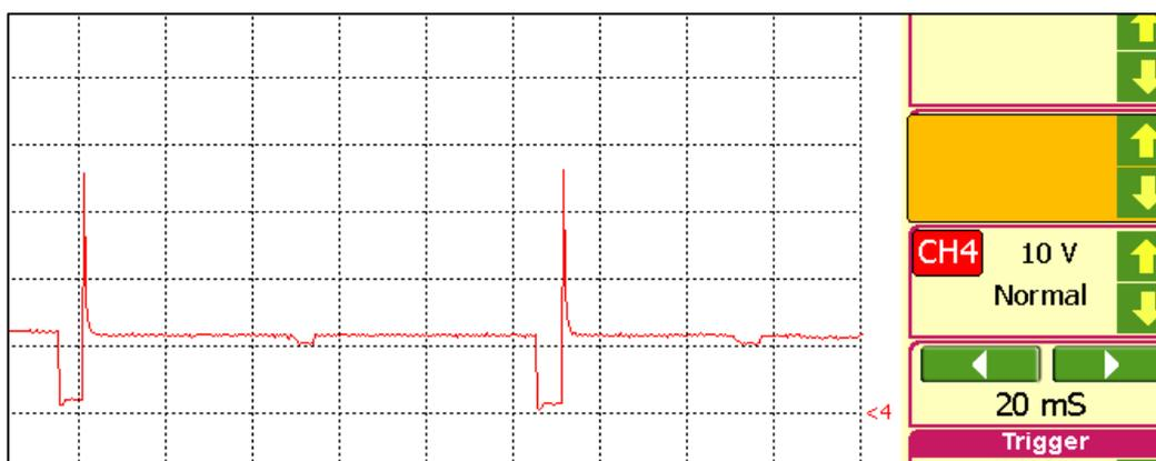
**Figura 61. Oscilograma del inyector del cilindro #6**
