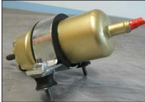
**Figura 24. Bomba eléctrica de combustible**
