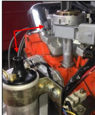
Figura 40. Bobina de encendido y distribuidor del motor Ford
