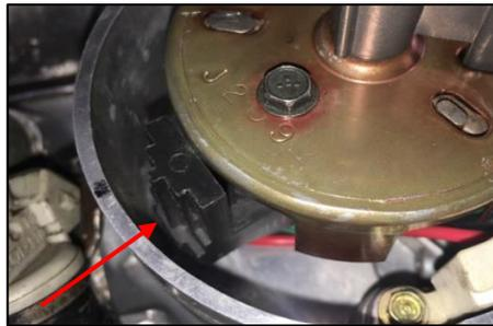
**Figura 36. Sensor PIP del motor Ford**
