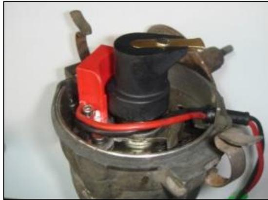
**Figura 26. Distribuidor electrónico**
