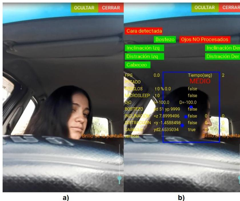
**Figura 40 Conductora con cabello que le cubre las mejillas: a) cara no detectada b) detección errónea de los puntos de referencia**
