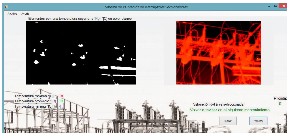
Figura 53: SVIS imagen IR6 seccionador B Valoración del área seleccionada.
