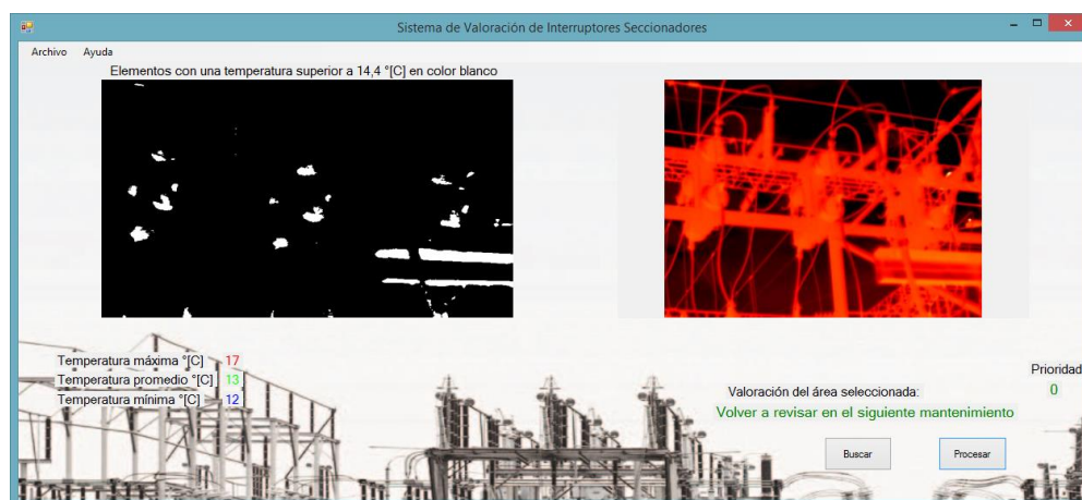
Figura 49: SVIS imagen IR6 seccionador A Valoración del área seleccionada
