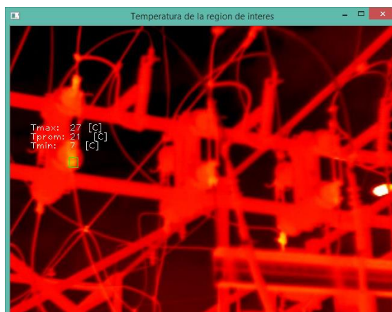
Figura 44: SVIS ventana con los indicadores de temperatura de la región de interés.
