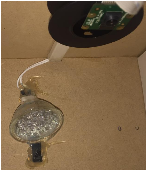
Figura 42: Sistema de iluminación
